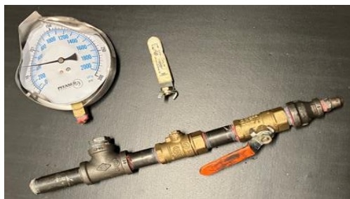
Fig. 13 – Arbre de test et manomètre après l'accident
