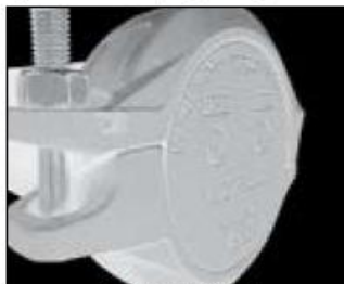
MONTAGE ADÉQUAT (LE CAPUCHON D'EXTRÉMITÉ EST ASSIS DANS L'ACCOUPLEMENT AVEC LA BONNE EXTRÉMITÉ VERS L'EXTÉRIEUR ET LES PATINS DE BOULONS EN CONTACT MÉTAL SUR MÉTAL)
