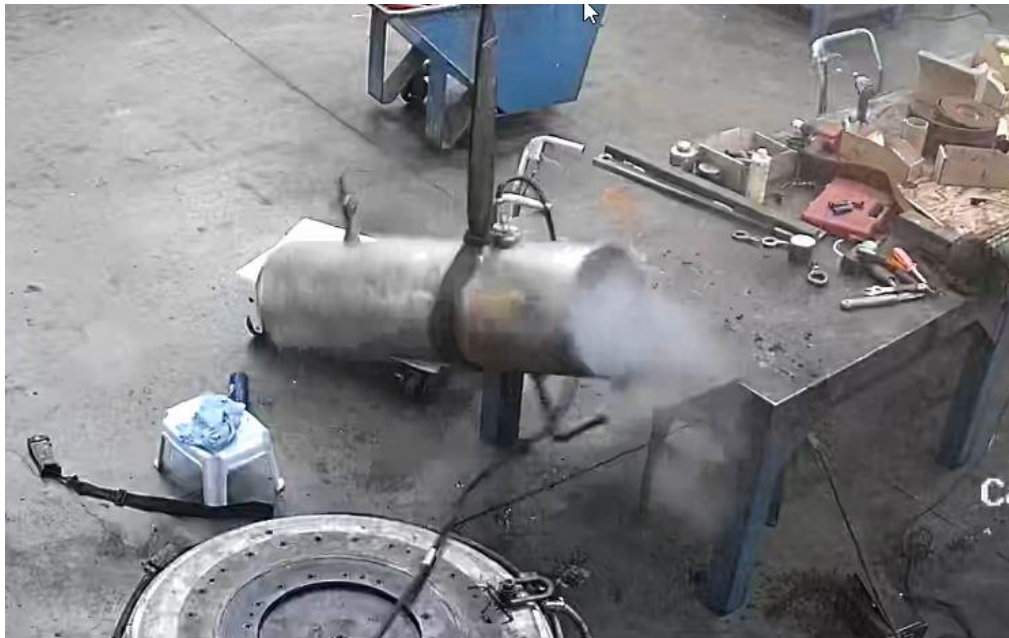
Figure 1 - Éclatement du réservoir
