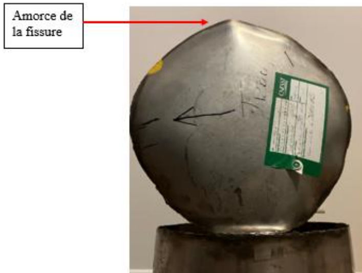
Fig. 9 – Zone de déformation Source : CNESST
