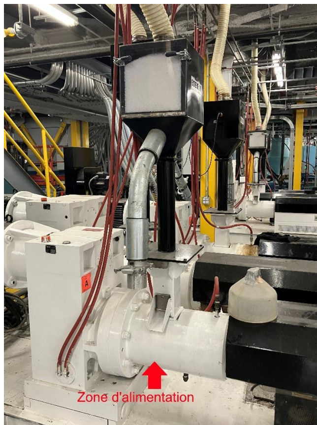
Fig. 6 - Zone d'alimentation de l'extrudeuse
