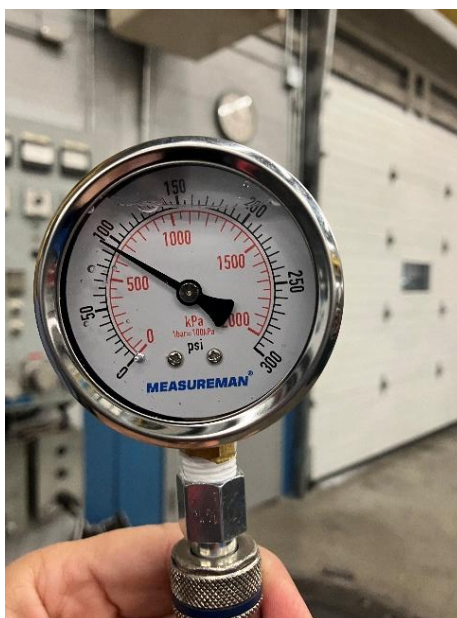
Fig. 9 - Mesure de la pression à la sortie du tuyau d'air comprimé Source : CNESST
