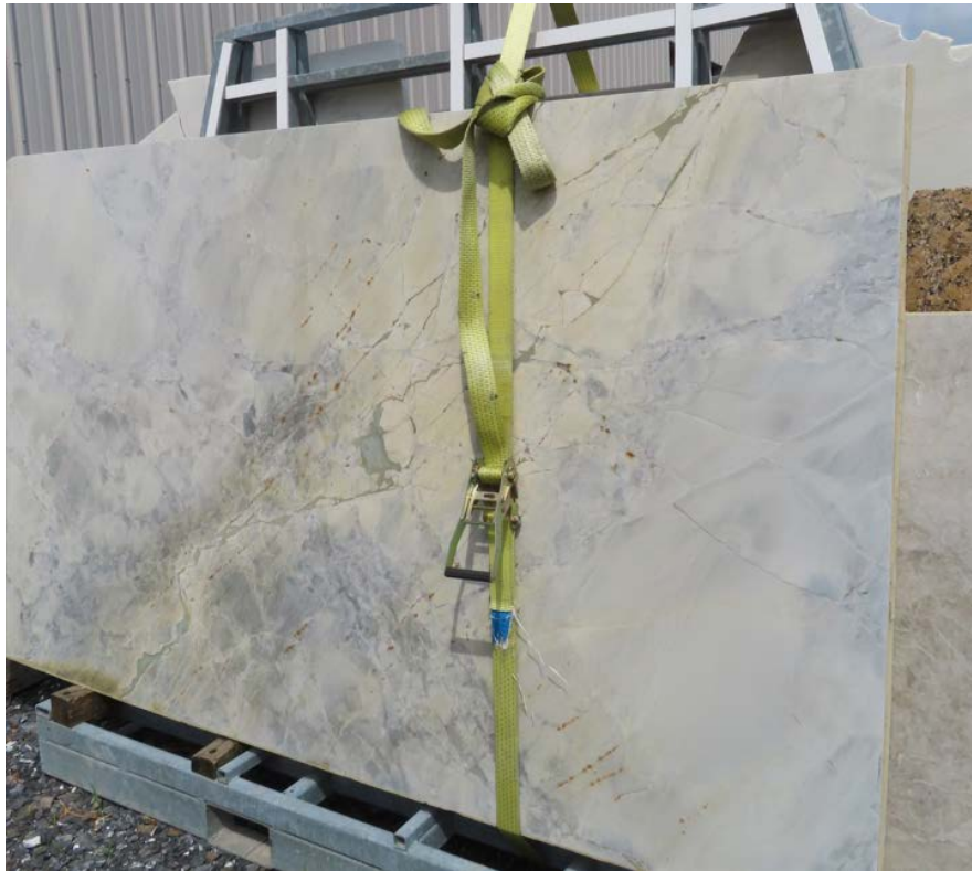
Fig. 5 — Exemple d'une sangle à cliquet qui ceinture de haut en bas les dalles de quartz Source : CNESST
