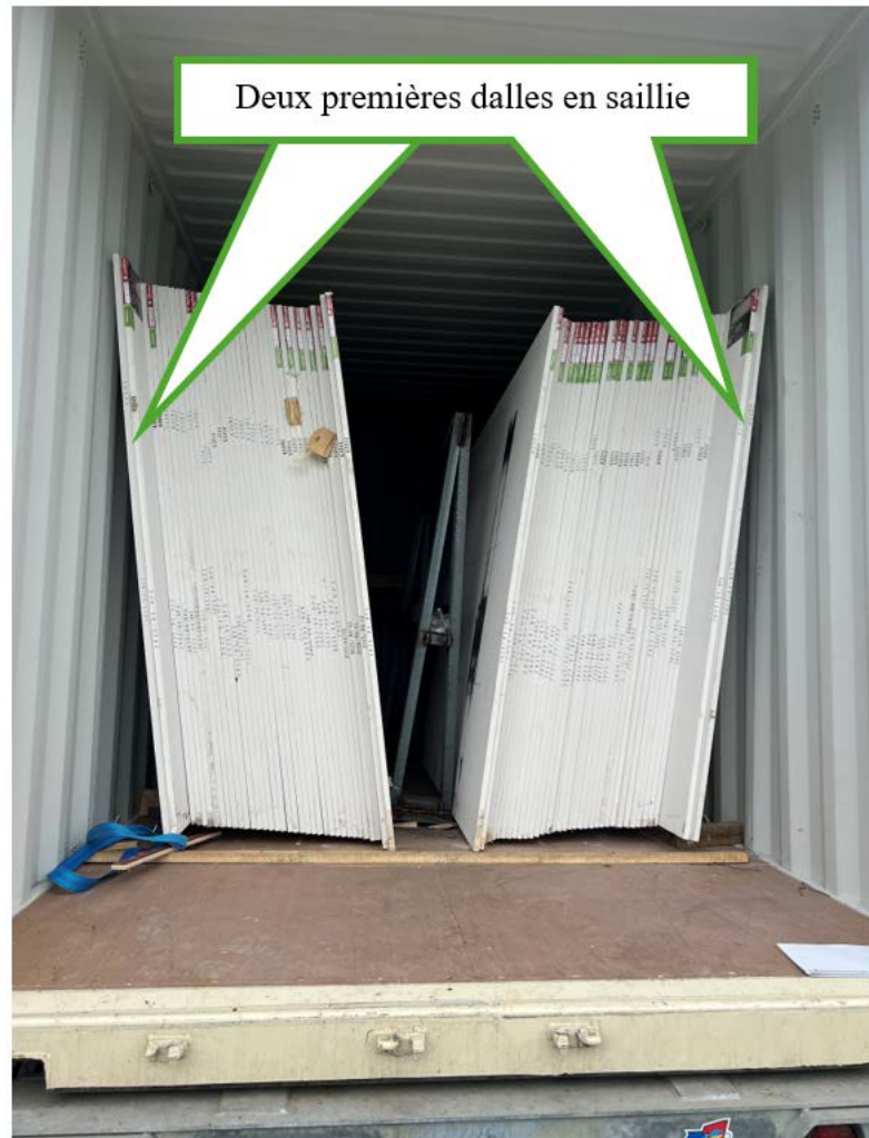
Fig. 9 – Positionnement des deux premières dalles en saillie
