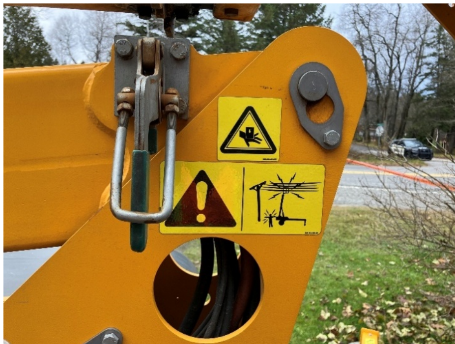
Fig. 5 - Photographie de la tourelle : pictogramme du risque électrique Source : CNESST
