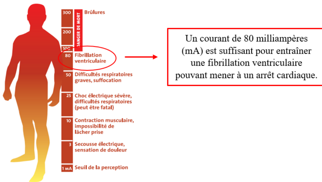
Fig. 14 - Intensité électrique et effets sur le corps
