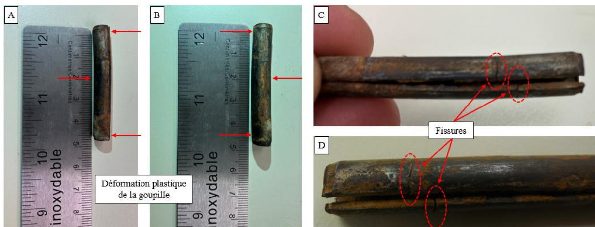
Fig. 12 – Fissures et déformation de la goupille du tirant droit
