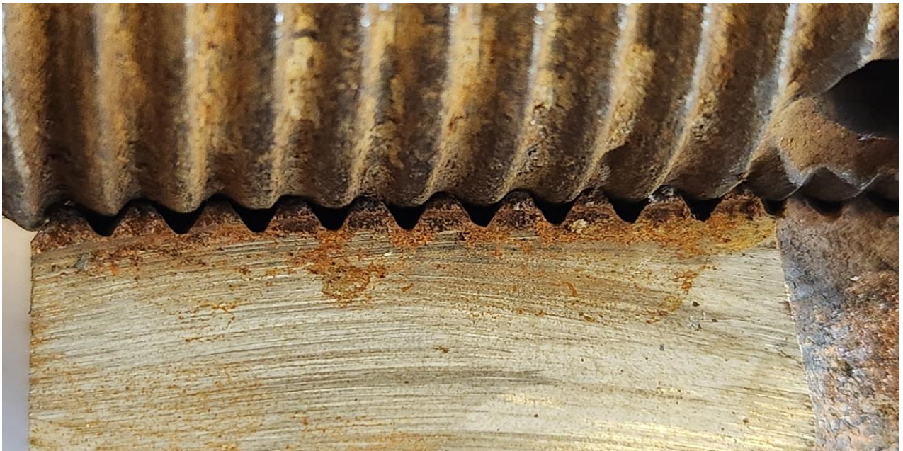
Photographie 4 : Perte d'engagement entre les filets. (Source CNESST).
