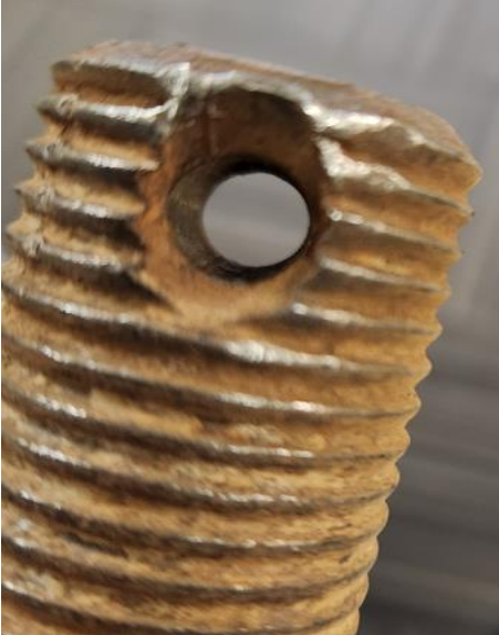
Photographie 2 : Trou dans la tige filetée permettant l'insertion de la goupille. (Source CNESST).
