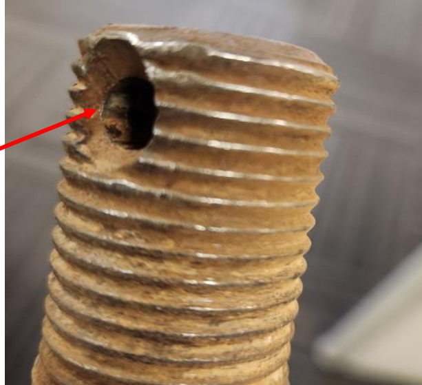
Photographie 5 : Fraisage sur un côté de la tige filetée. (Source CNESST).
