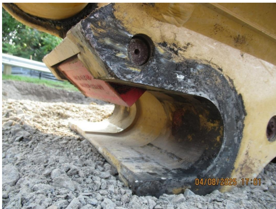
Fig. 24 - Loquet secondaire (en rouge) déployé
