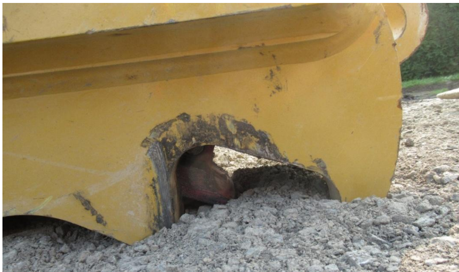
Fig. 23 - Coin primaire (en rouge) déployé Source : CNESST
