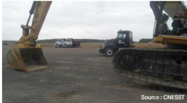
Photo 6 : Essai physique de vérification de l'engagement des axes du godet sur l'attache rapide
