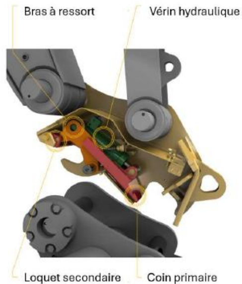
Figure 1 : Composantes du système de verrouillage de l'attache rapide (Source : Caterpillar, modifié CNEST)
