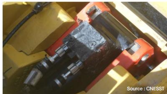
Photo 8 : Vue du système d'attache rapide sans panneau de protection de protection
