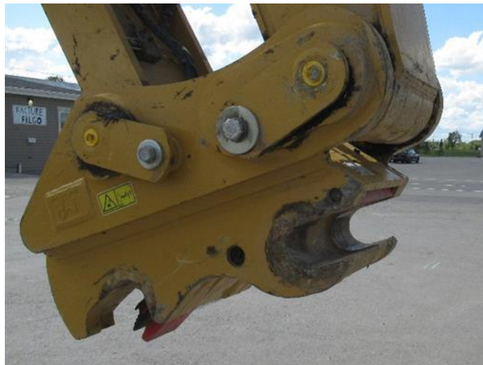
Fig. 28 - Loquet secondaire non déployé et coin primaire déployé Source : CNESST
