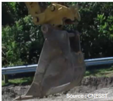
Photo 7 : Godet retenu seulement par le loquet secondaire
