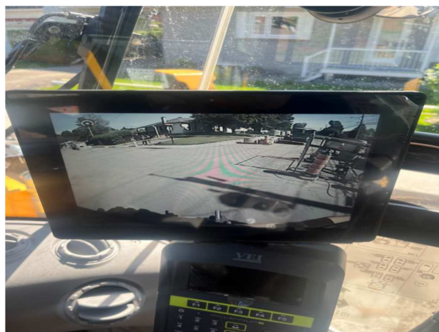
Fig. 6 – Vue de la caméra de recul sur l'écran à l'intérieur de la cabine
