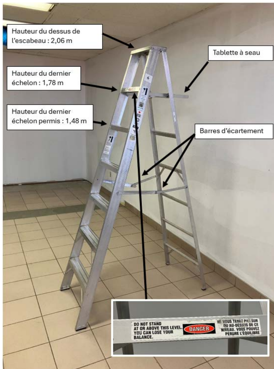
Fig. 5 - Dimensions et description de l'escabeau
