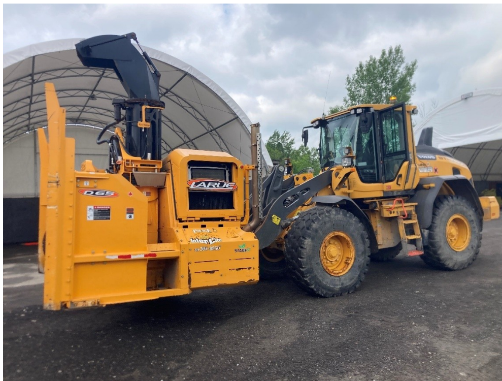
Fig. 10 - Position surélevée de la souffleuse à neige détachable comme au moment de l'accident
