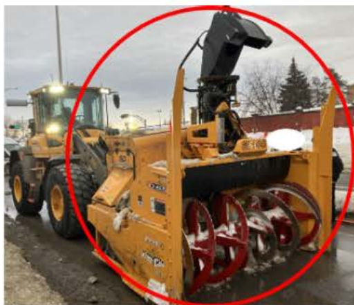
Fig. 12 - Photographie et tableau des caractéristiques de la souffleuse à neige détachable de marque Larue
