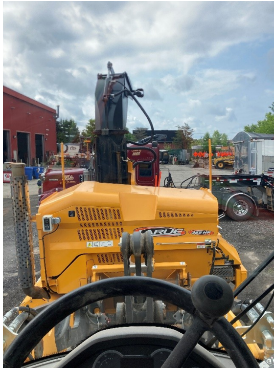
Fig. 16 - Angles morts causés par la souffleuse dans la configuration utilisée au moment de l'accident
