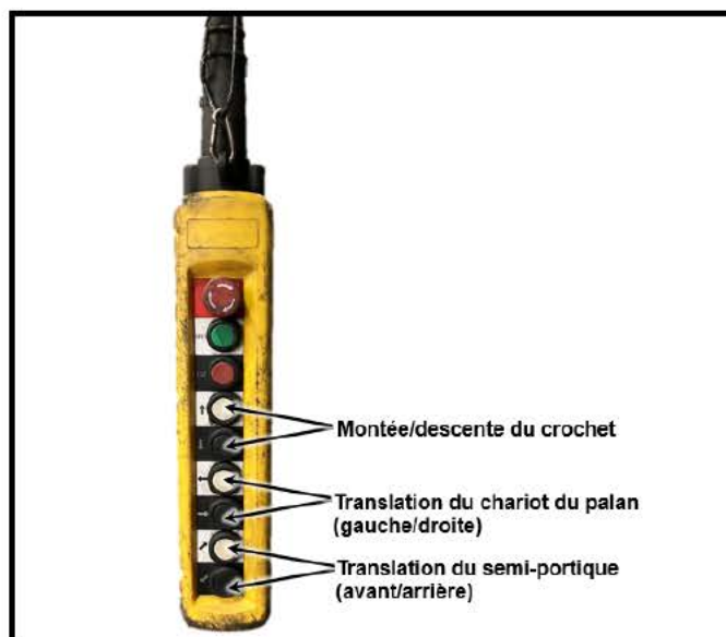
Fig. 9 – Commande du semi-portique utilisée pour le chargement de bobines (Source : CNESST)
