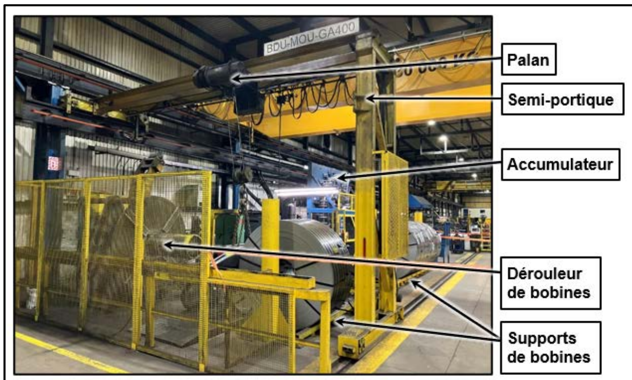
Fig. 5 – Aménagement des équipements situés à proximité du dérouleur de bobines (Source : CNESST)
