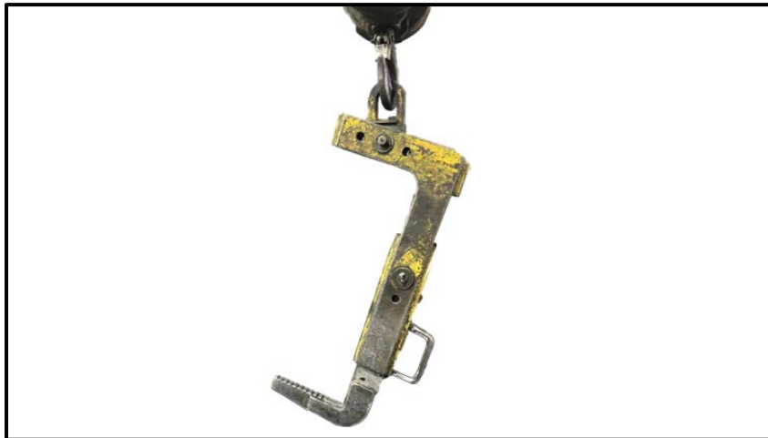
Fig. 10 – Palonnier (crochet en « C ») utilisé pour la manutention des bobines d'acier à l'aide du semi-portique (Source : CNESST)
