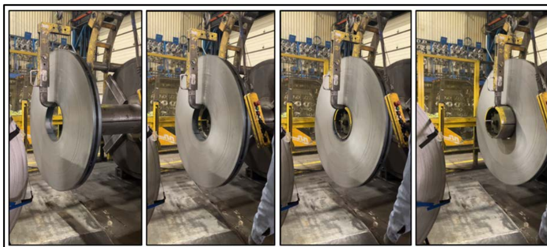
Fig. 7 – Chargement d'une bobine d'acier sur le mandrin du dérouleur à l'aide du semi-portique (Source : CNESST)
