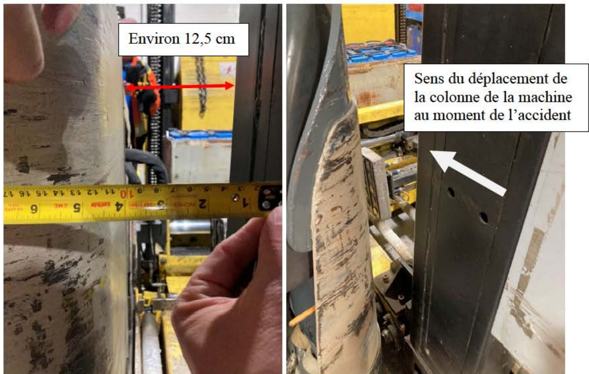
Fig. 19 et 20 – Zone de coincement évaluée entre la colonne avant droite de la machine en déplacement et la structure du chariot élévateur stationné Source : CNESST
