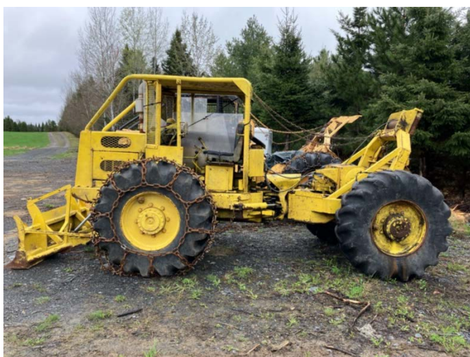
Fig. 8 : Débardeur sur roues
