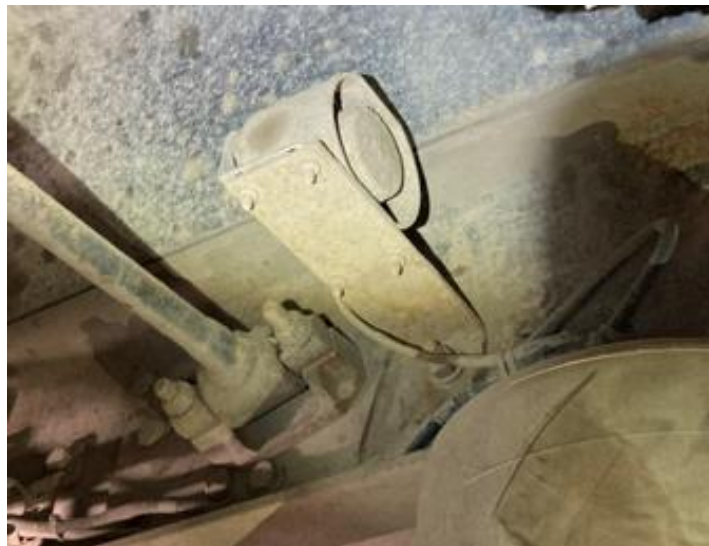
Fig. 5 - Photo de l'alarme de recul Source : CNESST
