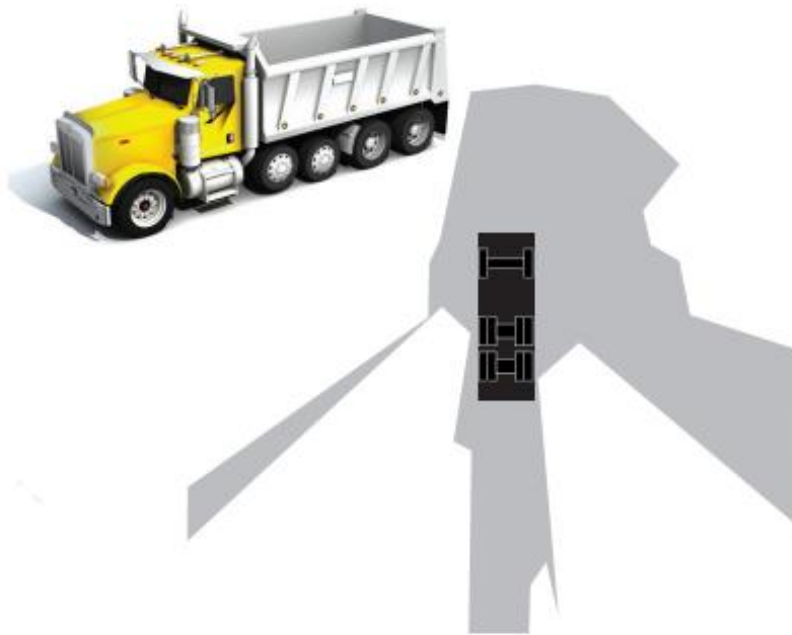
Fig. 6 - Angles morts sur un véhicule lourd (exemple à titre informatif seulement)
