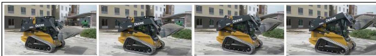
Fig. 10 – Godet de la chargeuse compacte modèle 325G soulevé à différentes hauteurs
