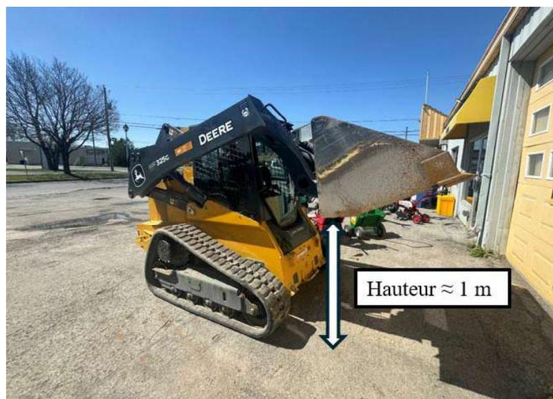
Fig. 5 – *Chargeuse compacte avec le godet surélevé*
