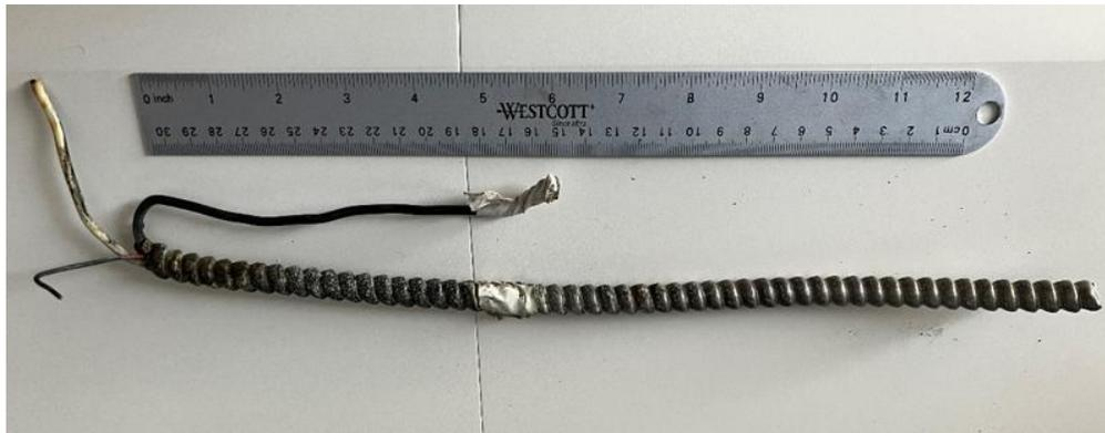
Fig. 15 – Câble armé métallique contenant les fils électriques liés à l'interrupteur Bob1
