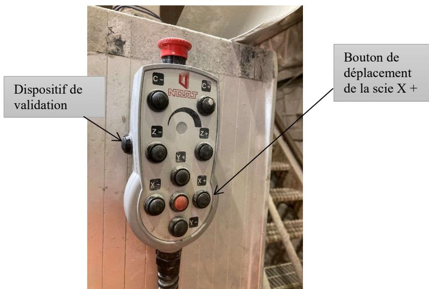
Fig. 14 - Télécommande filaire en cause dans l'accident
