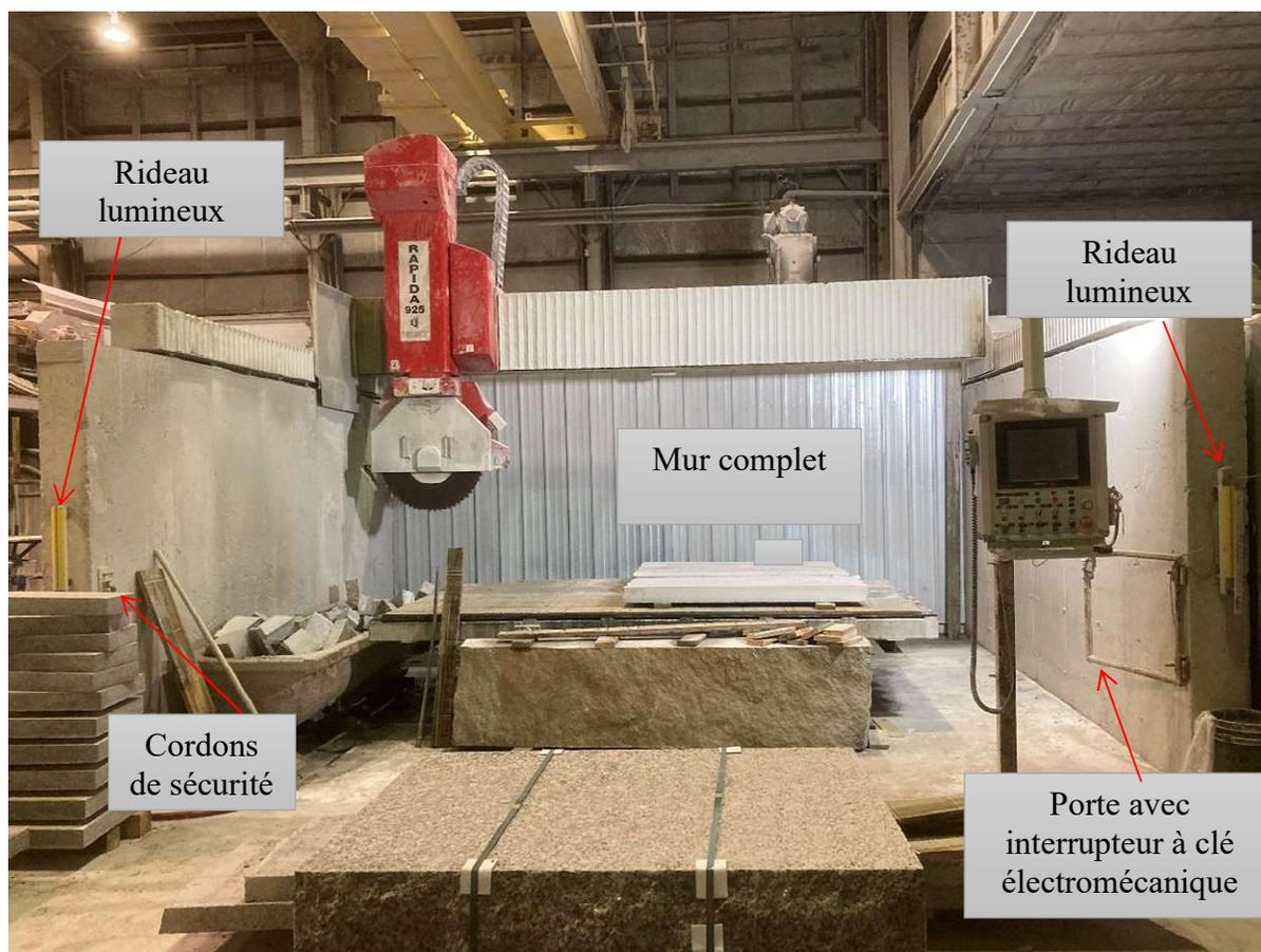
Fig. 19 - *Emplacement des dispositifs de sécurité*
