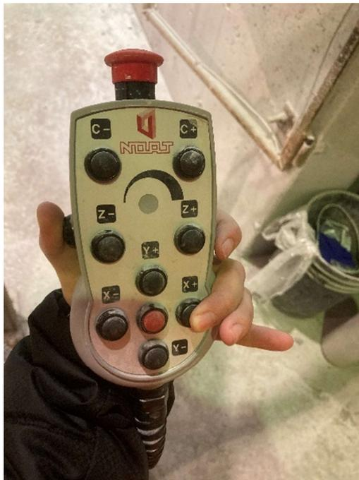
Fig. 15 - Actionnement des deux boutons à l'aide d'une seule main
