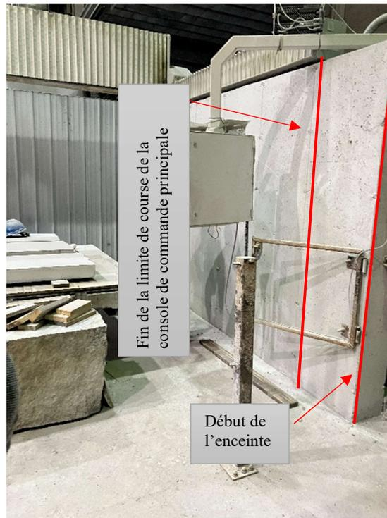
Fig. 10 - Console de commande principale /enceinte de la machine
