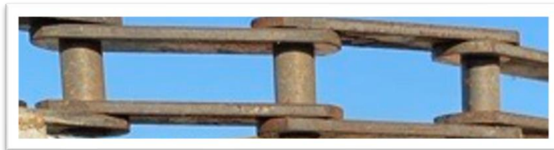
Fig. 8 - Exemple d'une section de chaîne formée de mailles
