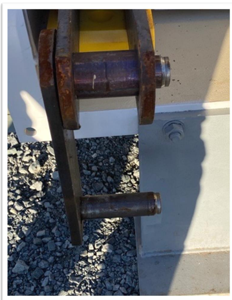
Fig. 10 - Vue d'une maille patente sans plaque latérale
