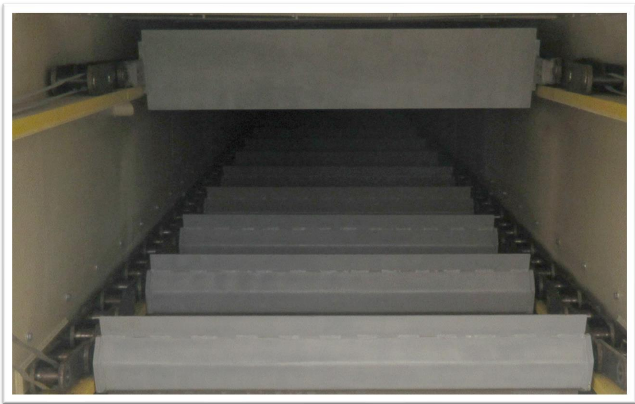
Fig. 11 - Exemple de raclettes sur des combinés chaînes-raclettes dans un caisson de convoyeur
