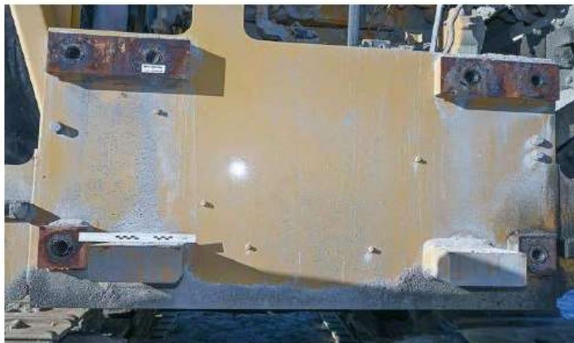
Figure 10 : Plaque de fixation et supports en sailli intégrés à l'excavatrice. (Source CNESST)
