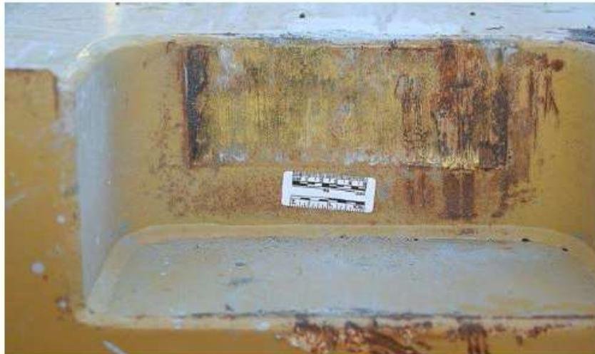
Figure 9 : Trace de l'appui du contrepoids sur les supports de l'excavatrice. (Source CNESST)
