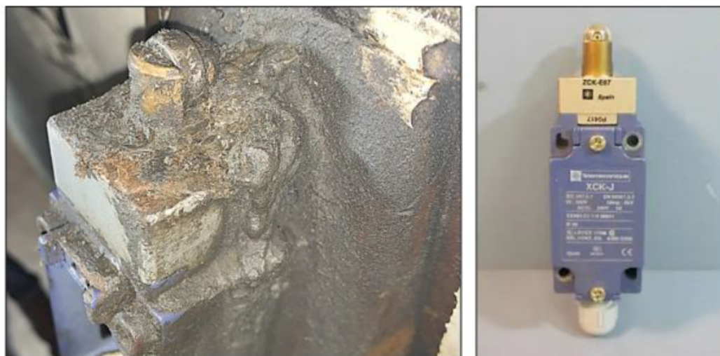
Figure 15: Comparaison du poussoir de l'interrupteur avec un modèle neuf 22,23
