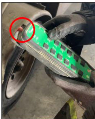
Figure 11: Arrêt d'urgence de la télécommande
