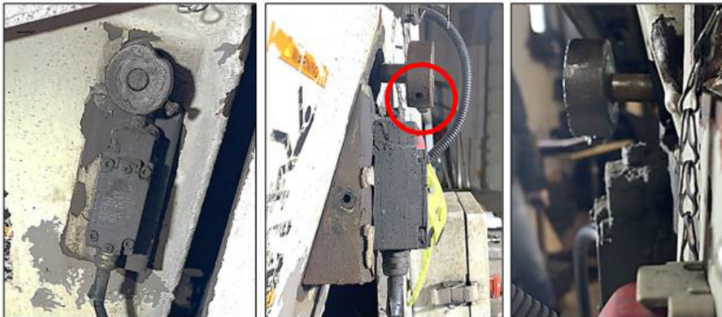
Figure 13: État de l'interrupteur de position et de la came au moment du retrait du capot
