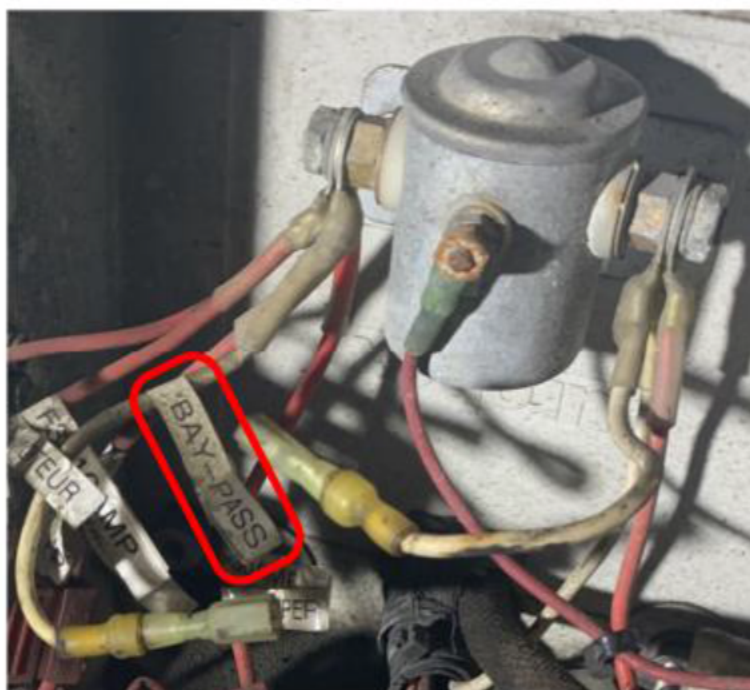
Figure 21: Fil de contournement de la fonction d'arrêt d'urgence
