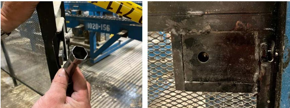
Fig. 24 – Clef hexagonale et serrure à ouverture quart de tour des portes secondaires
