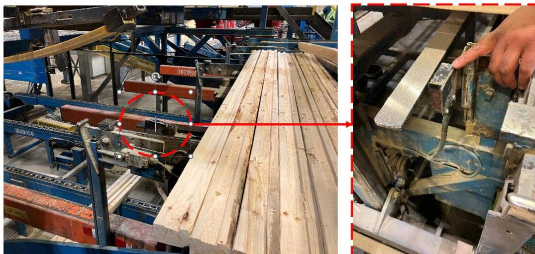
Fig. 11 - Cellule photoélectrique
