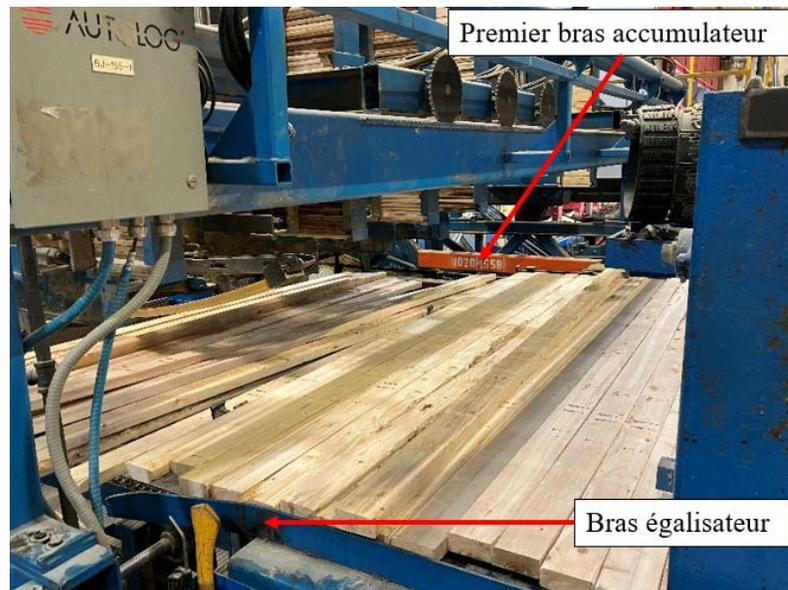
Fig. 6 - Niveau supérieur de l'empileuse :
