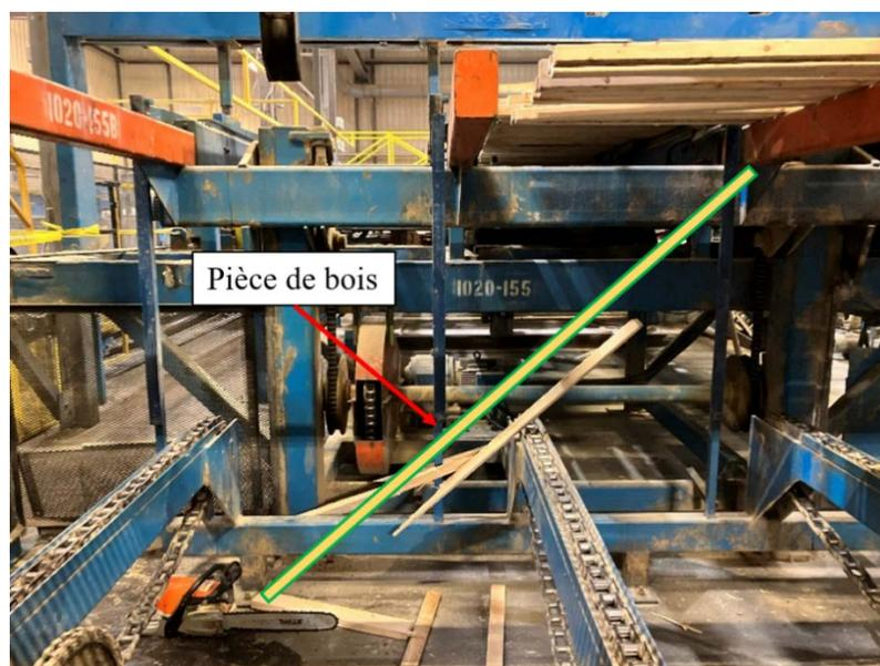
Fig. 22 - Position retenue de la pièce de bois lors du blocage de l'élévateur
