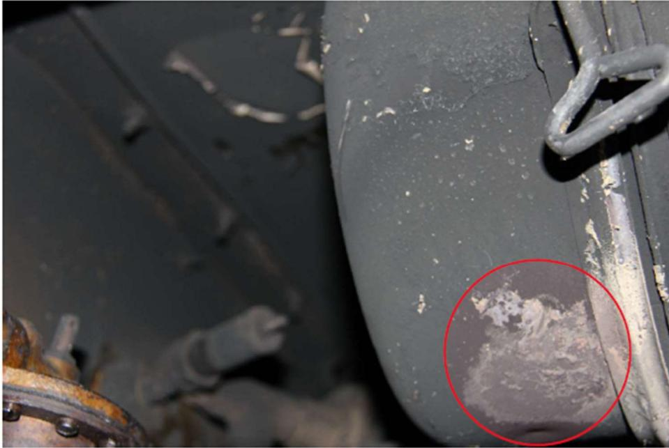
*Fig. 6 – Bol du filtre à air, directement au-dessus de la sortie du réservoir d'huile « chauffée à blanc »*
