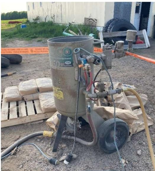
Fig. 5 - Pot à jet d'abrasif Clemco
