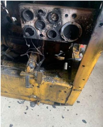
*Fig. 2 - Panneau de contrôle brûlé*
