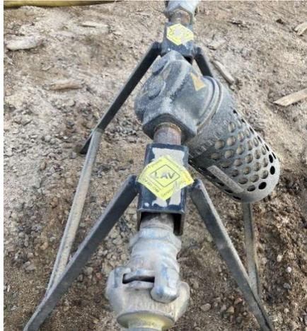
Fig. 6 - *Filtre à air High Flow Vanguard*
