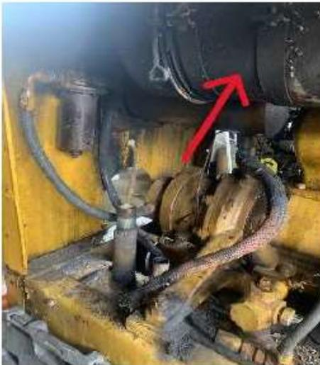
Boîtier du filtre à air moteur et compresseur
