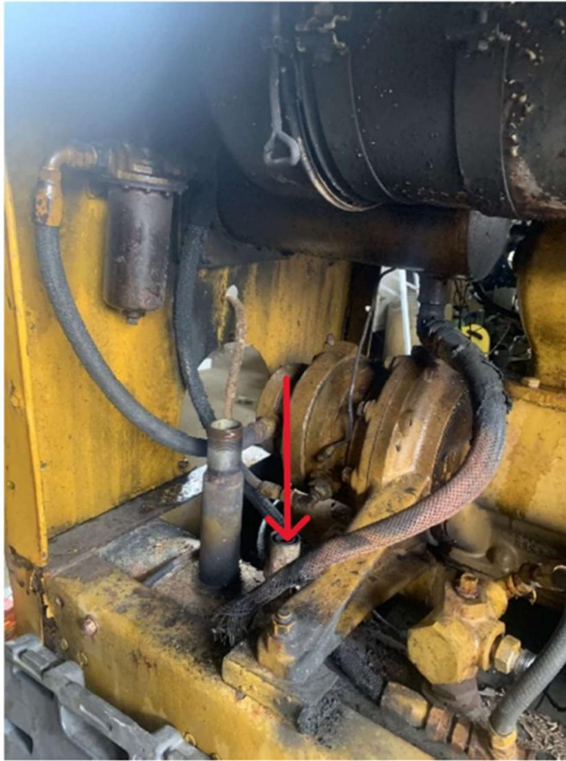
*Fig.3 – Boyau de sortie air/huile vers le séparateur, brûlé et sectionné*
