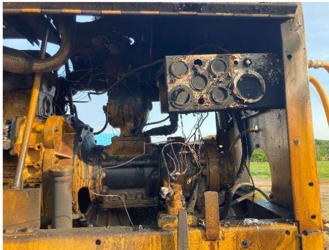
Fig. 11 - Panneau de contrôle brûlé
