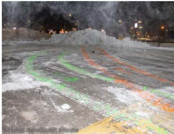
Fig. 19 et 20 – Vues du tracé des déplacements de la chargeuse sur roues à proximité du banc de neige n° 2 (peinture en orange : marche avant et peinture en vert : marche arrière).
