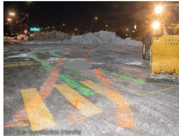
Fig. 19 et 20 – Vues du tracé des déplacements de la chargeuse sur roues à proximité du banc de neige n° 2 (peinture en orange : marche avant et peinture en vert : marche arrière).
