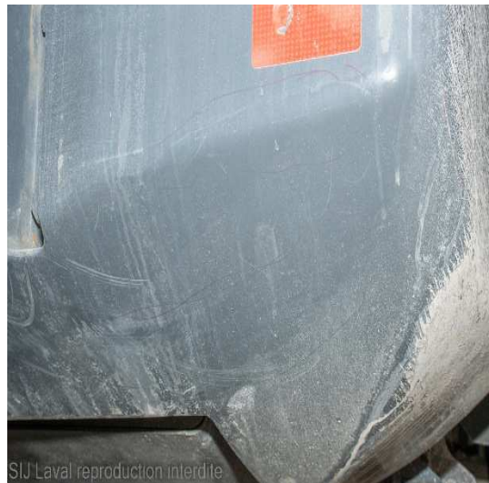
Fig. 17 et 18 – La hauteur du bassin de B correspond à la hauteur des traces d'essuyage sur le pare-chocs arrière de la chargeuse sur roues Source : Service de police de Laval
