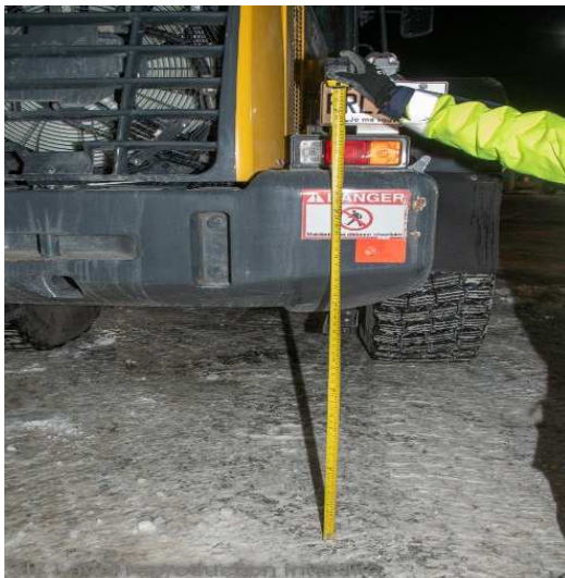
Fig. 17 et 18 – La hauteur du bassin de B correspond à la hauteur des traces d'essuyage sur le pare-chocs arrière de la chargeuse sur roues Source : Service de police de Laval
