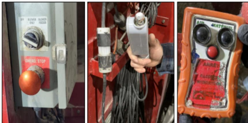
Figure 9: Panneau de commande et télécommandes (avec et sans fil)
