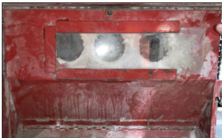
Figure 17: Protecteur fixe de la valve rotative
