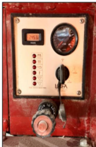
Figure 10: Panneau de commande du moteur diesel
