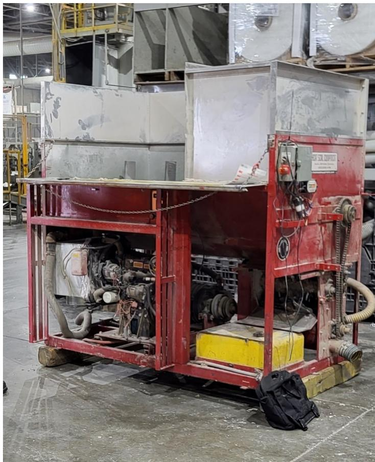
Fig.7 – Machine à souffler la cellulose HS 5500 (protecteurs absents)
