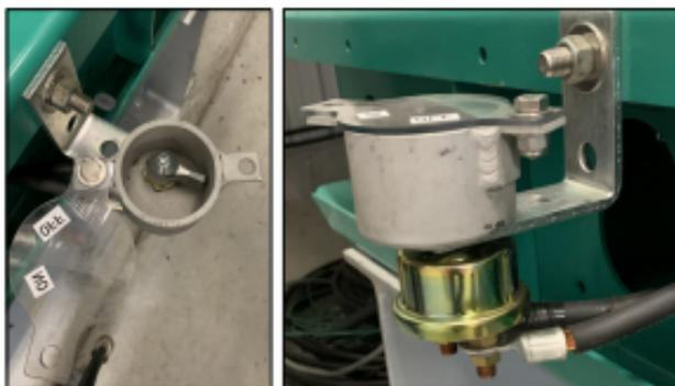
Figure 25: Exemple d'interrupteur pour moteur à combustion
