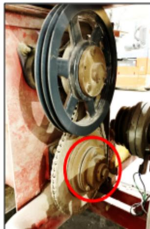
Figure 12: Détail du limiteur de couple
