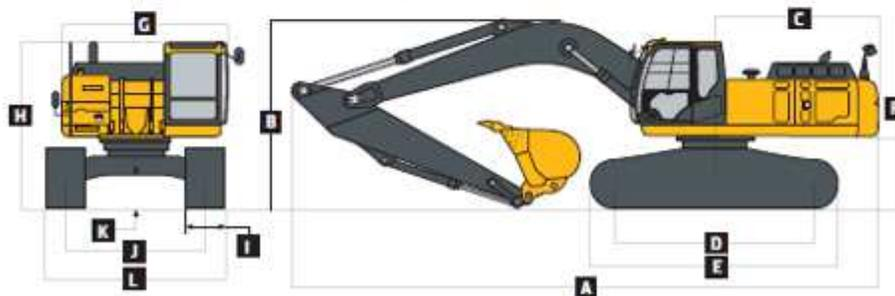
Image 2 : Dimensions de la pelle mécanique
