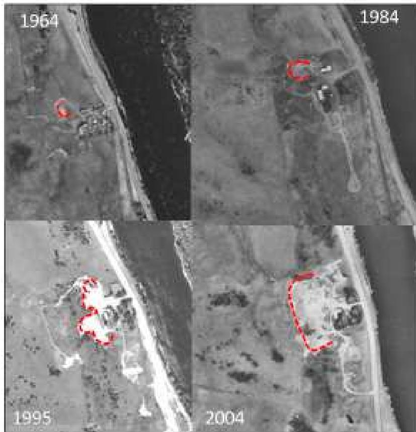
Figure 2.2: Montage de photographies aériennes de la sablière entre 1964 et 2004. Les lignes rouges indiquent les limites approximatives de la sablière à chaque époque.
