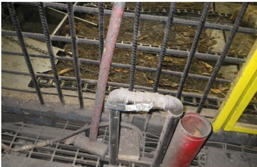
Fig. 8 — Valve manuelle ouverte — alimentation du système pneumatique du sélecteur de billes située au poste d'opérateur du monte-billes Source : CNESST
