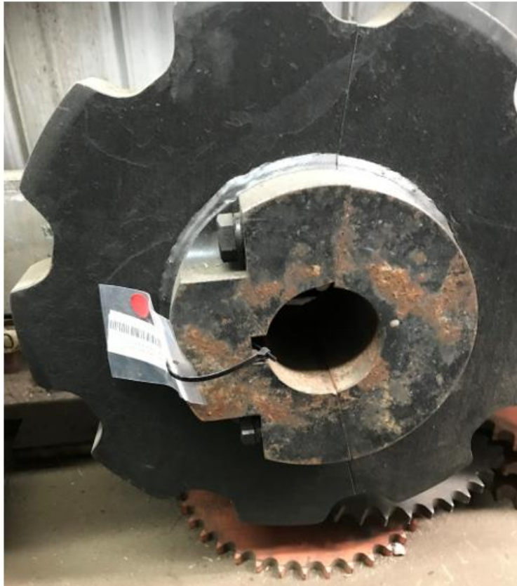
Fig. 5 — Roue dentée en deux sections semblable à celles utilisées au monte-billes Source : CNESST
