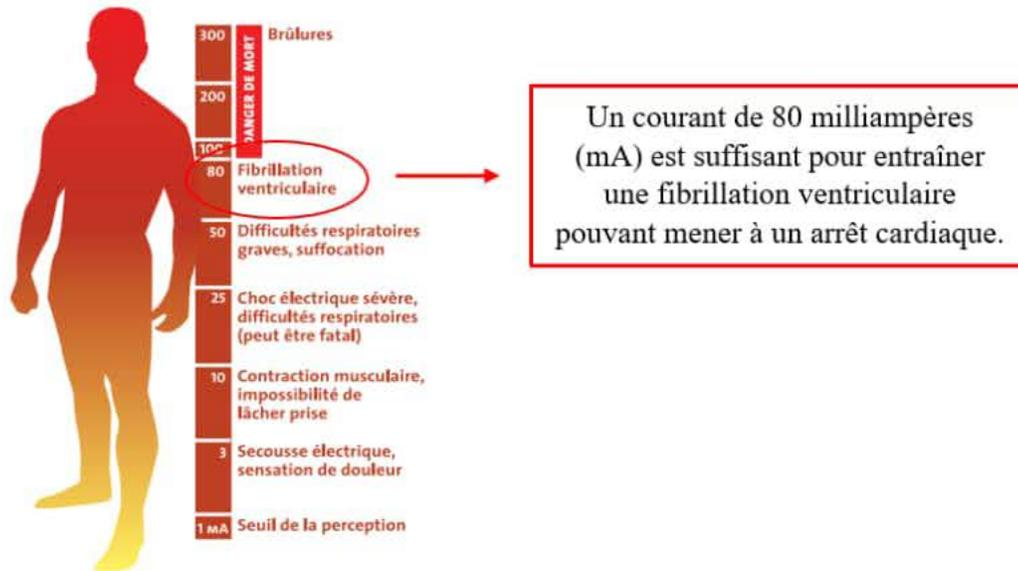
Fig. 13 - Intensité électrique et effets sur le corps
