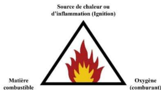
Fig. 20 - Schéma du triangle de feu Source : CNESST
