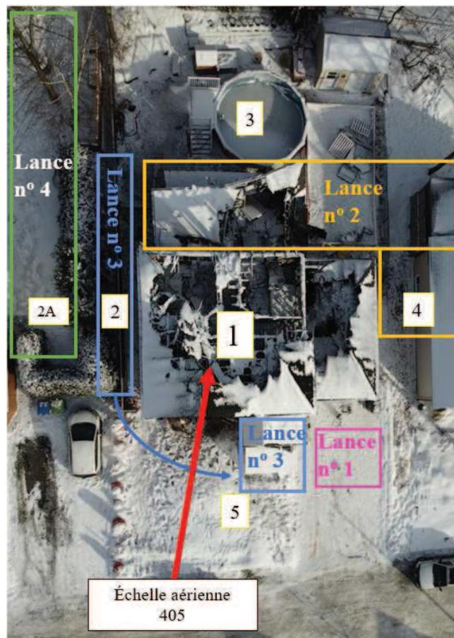
Fig. 10 - *Emplacement des lances incendie utilisées*
