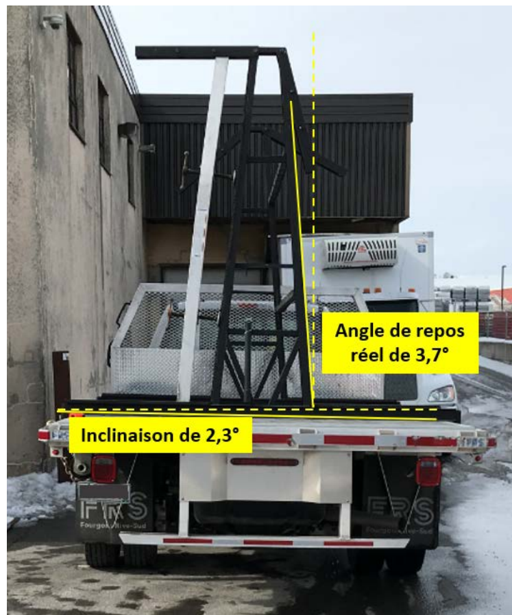
Fig. 9 : Angle de repos des dalles mesuré et inclinaison du terrain Source : Photo et modifications CNESST
