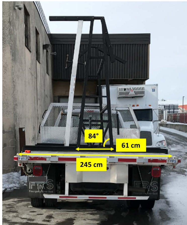
Fig. 7 : Dimensions du support de dalles en « A »
