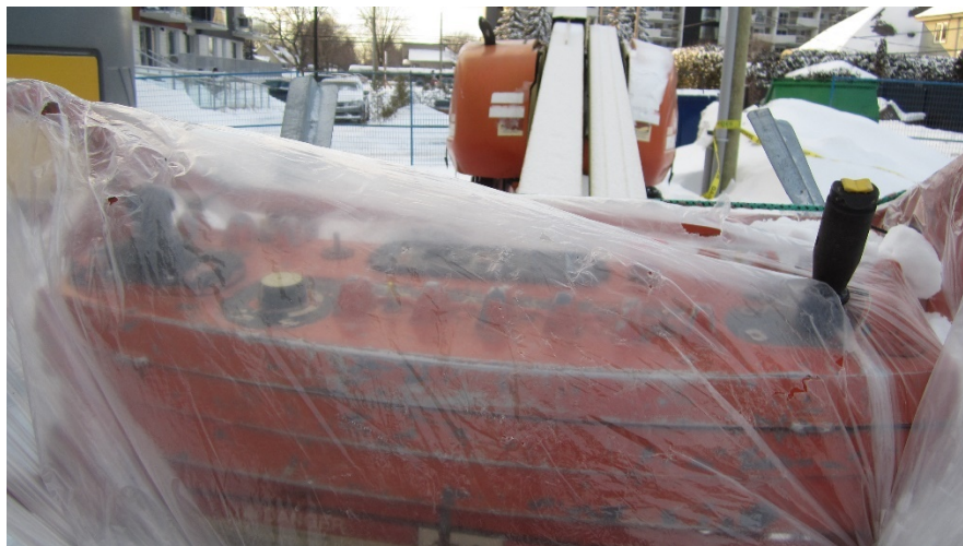
Fig. 3 - Photographie du panneau de commandes de la plateforme élévatrice utilisée Source : CNESST
