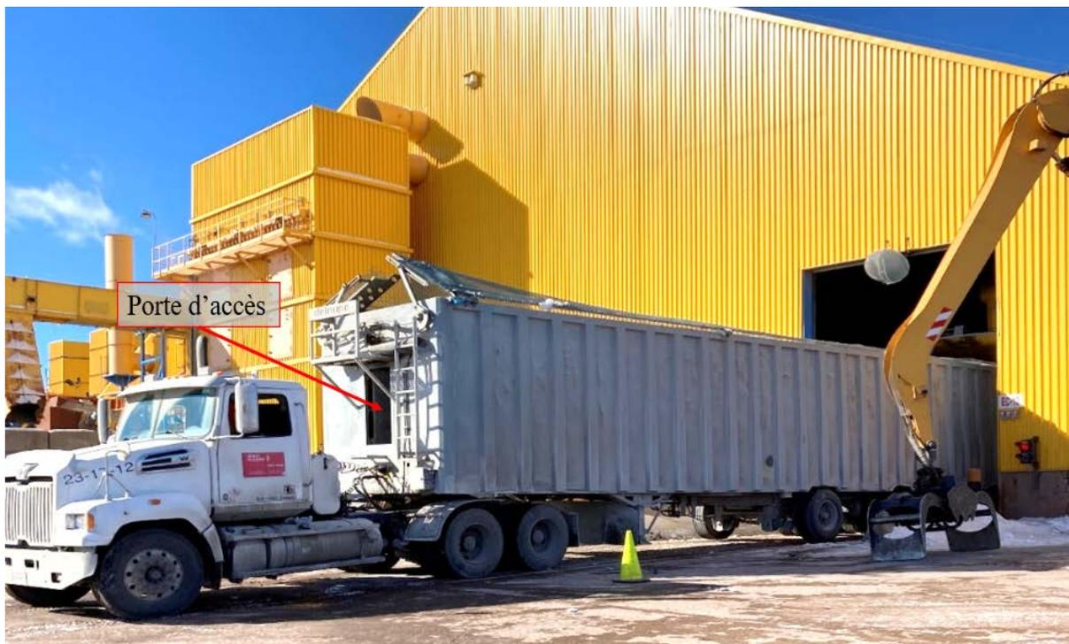
Fig. 6 - Tracteur routier et semi-remorque à plancher mobile
