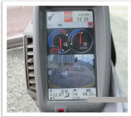
Fig. 7 : Moniteur de la caméra Source : CNESST
