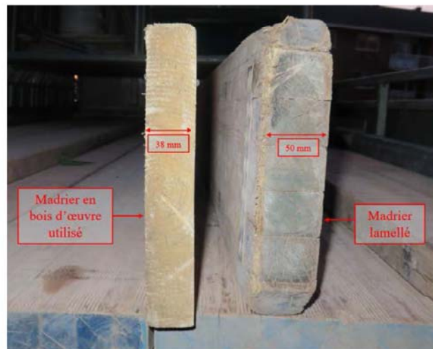
Figure 11 – Madrier en bois d'œuvre de catégorie n°2 et madrier lamellé certifié CSA Source : CNESST
