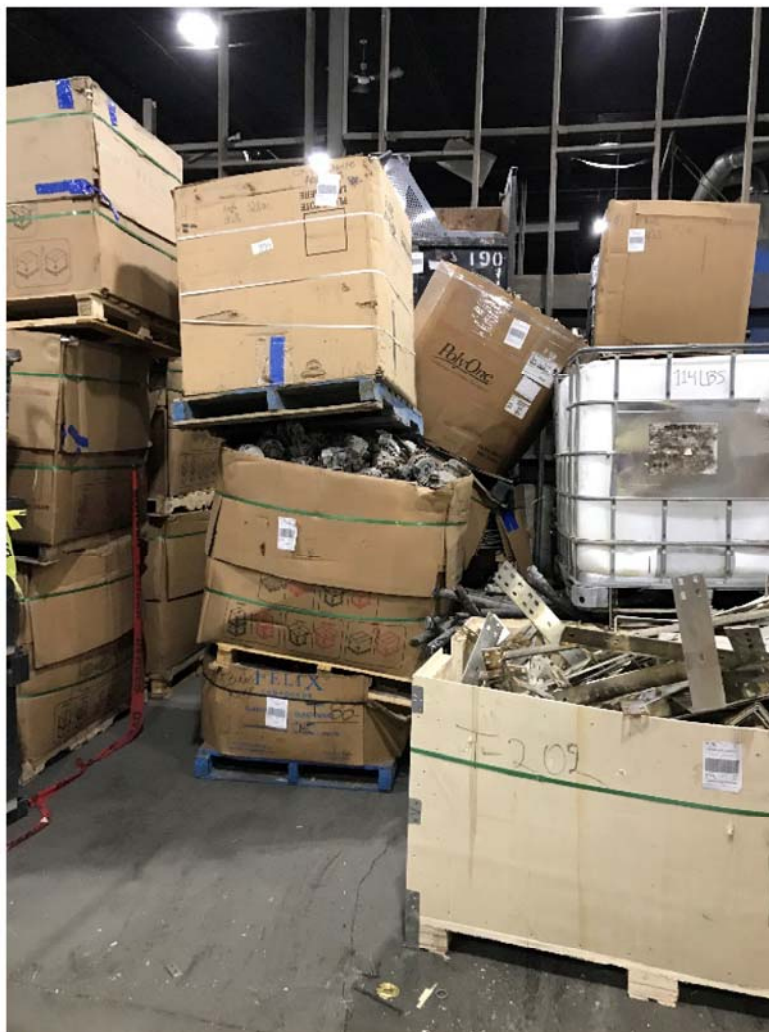
Photo 7 : Empilement instable de boîtes de carton sur palettes (source : CNESST)
