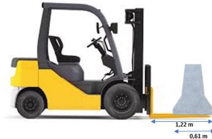
Figure 15 : Méthode de travail utilisée pour la manutention des glissières en béton pour chantiers (Source de l'image : https://www.irsst.qc.ca/media/documents/PubIRSST/RF-800.pdf , modifiée par la CNESST)
