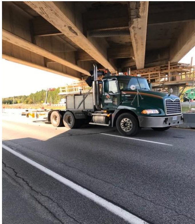
Figure 13 : Véhicule de protection avec atténuateur d'impact fixé à un véhicule (VP-AIFV) (Source : CNESST)
