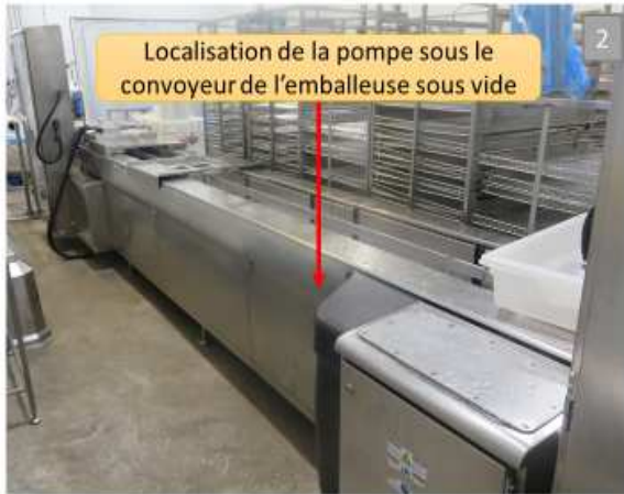
Photos 2 & 3 : Convoyeur de l'emballeuse sous vide et pompe à remplacer
