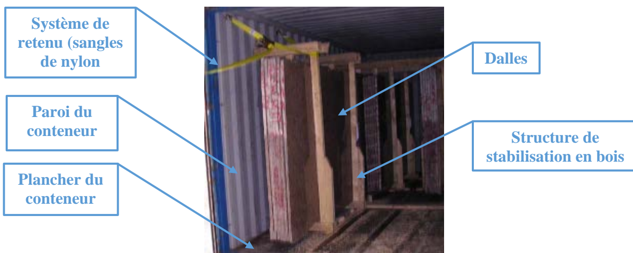
Photo 9 : Sécurisation d'un paquet de dalles à la paroi d'un conteneur
