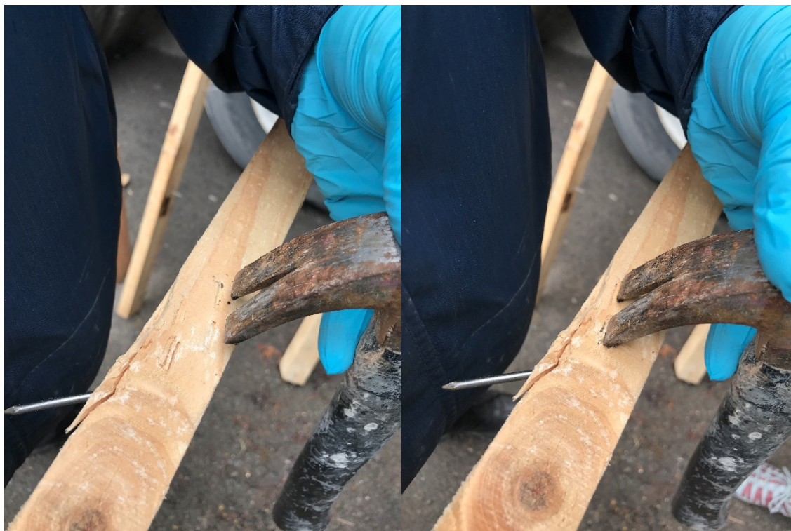
Photos 6-7 : Marques laissées par les oreilles du marteau sur la traverse horizontale - reconstitution
