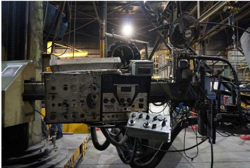
Photo 7 : Panneau de commande du positionneur 61 et du manipulateur de soudage 60
