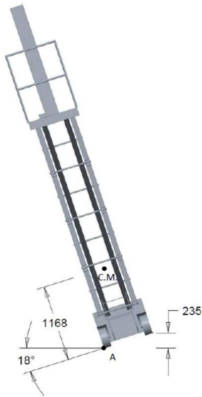
Figure 2. Inclinaison à l'angle limite de stabilité. Le centre de masse est exactement au-dessus du point A, dimensions en mm.
