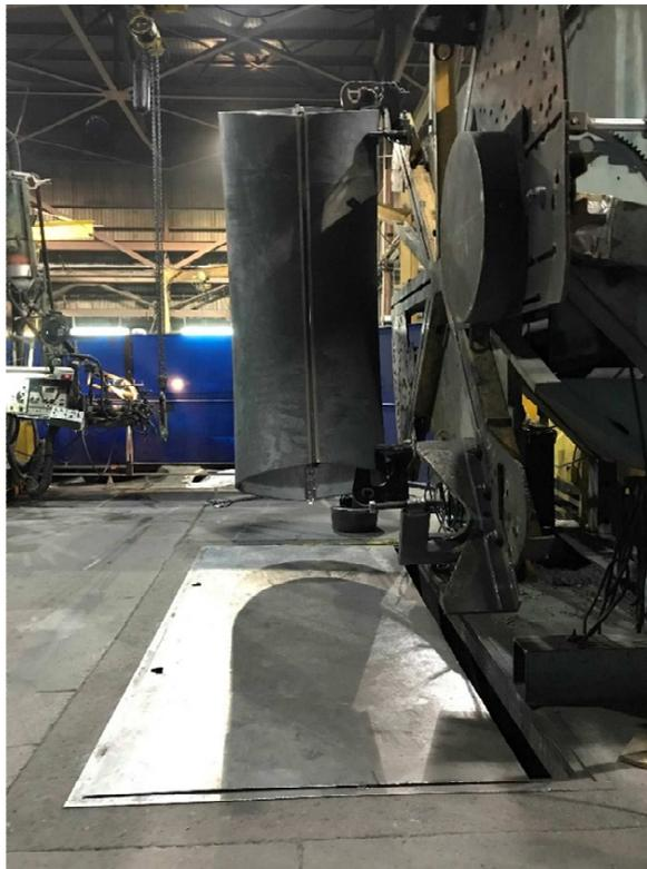
Photo 12 : Plaque métallique sur l'ouverture en avant du positionneur 61
