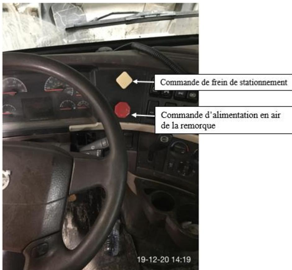
Fig. 10 – *Commande de frein de stationnement*
