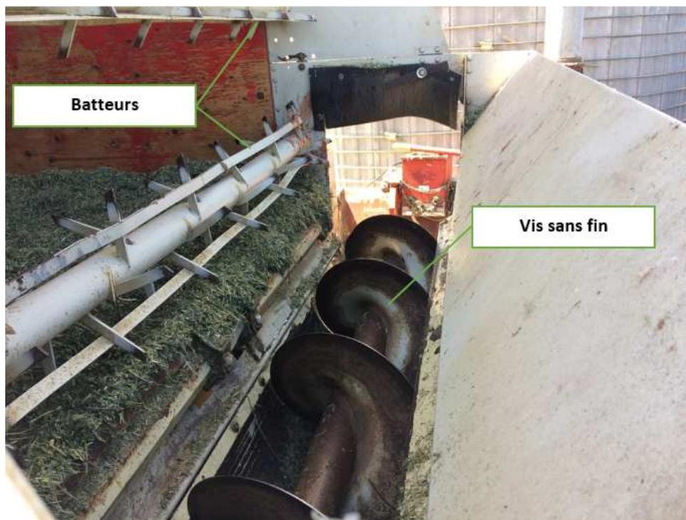
**Figure 2 : Vis sans fin (Source : CNESST)**
