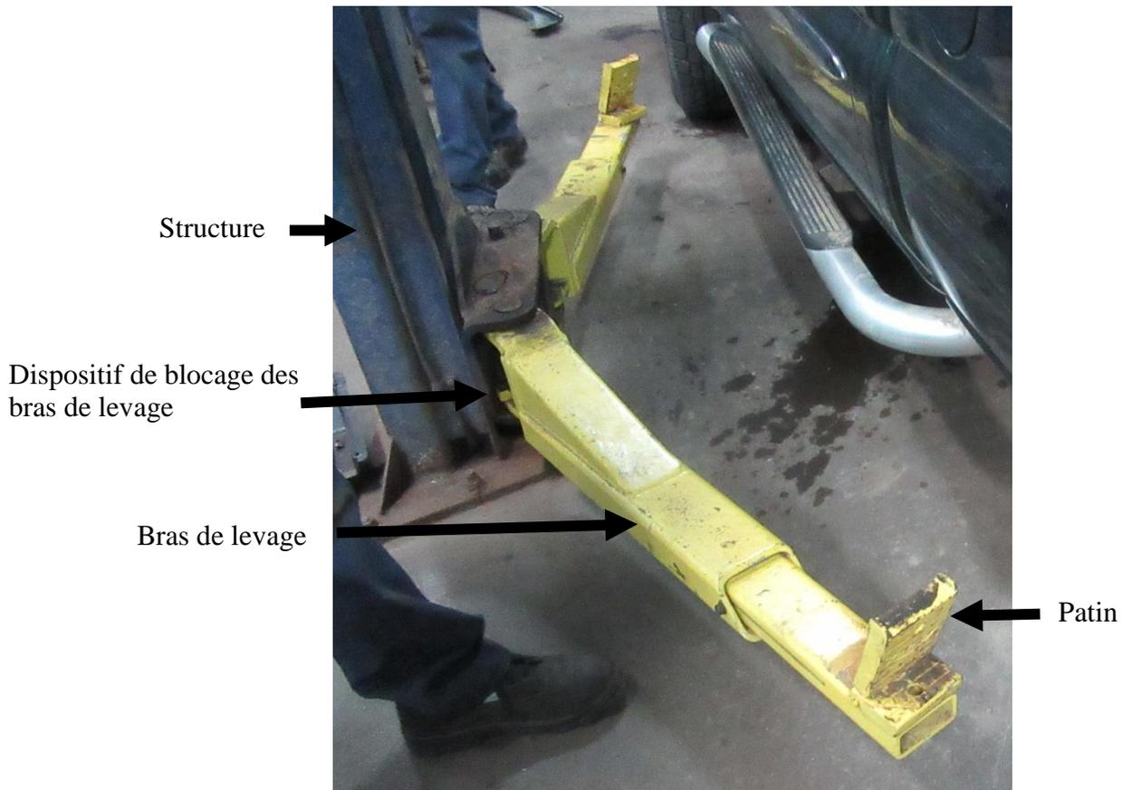
Fig. 4 — *Pont élévateur Rotary SPO9*
