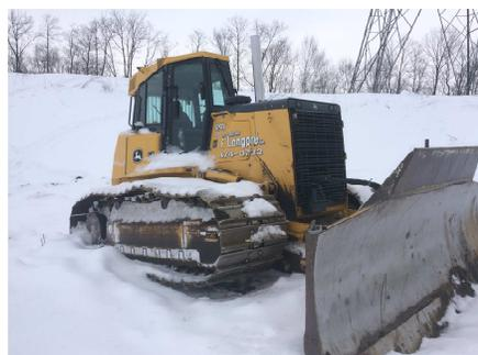
Photo 6 : Boteur utilisé comme point d'ancrage
