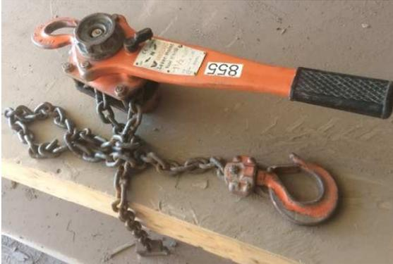
Photo 10 : Palan à levier utilisé par les travailleurs
