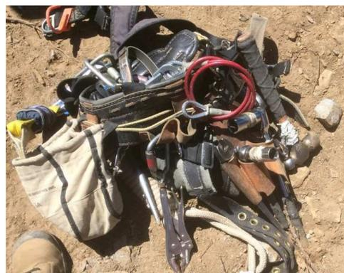
Photo 9 : Outils manuels utilisés par les monteurs
