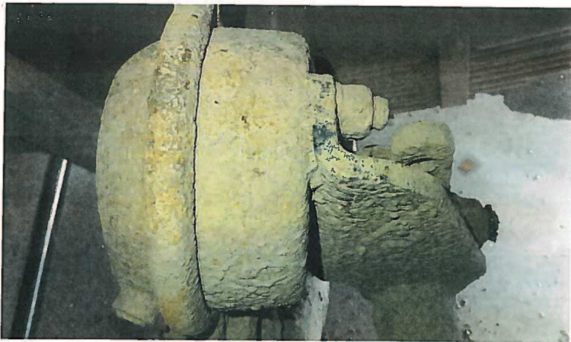
recepteur de freinage 2 iem essieux direction droit
