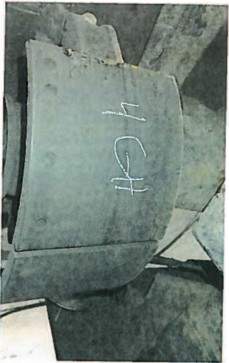
Sabot freins 4ième ess.g. (13mm)
