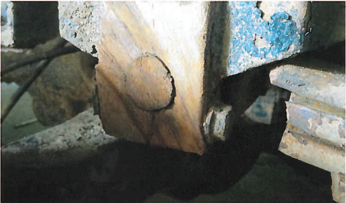
bague d ancrage suspension gauche
