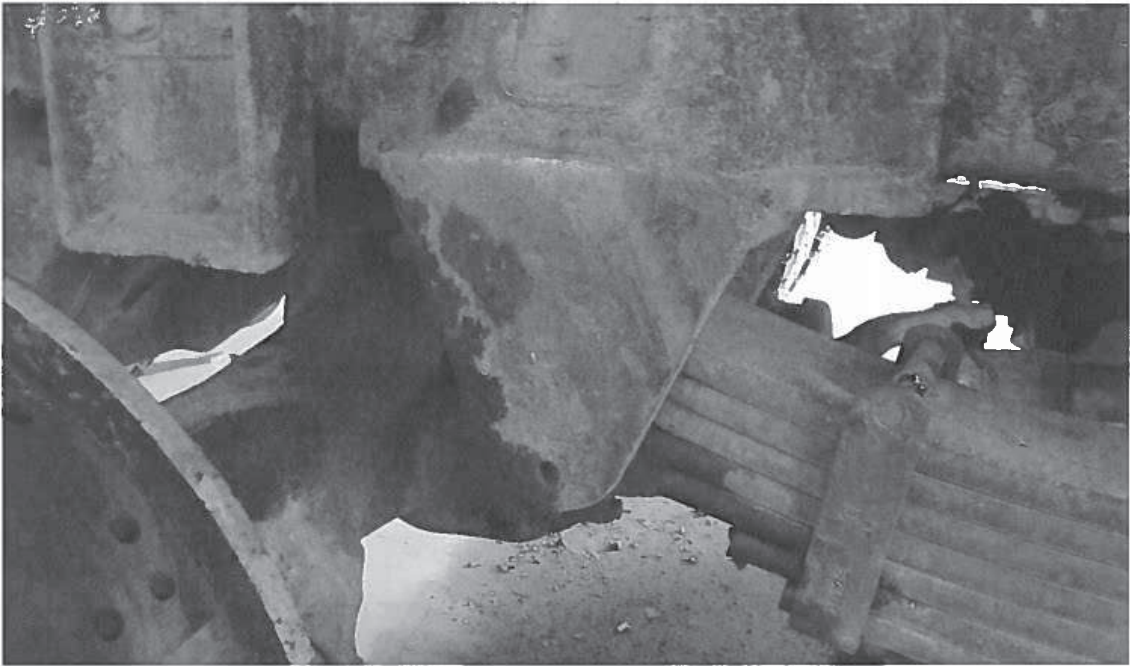
pieces de fixation essieux arriere droit
