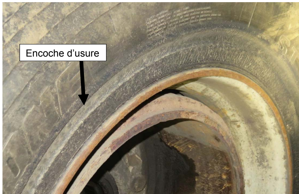
Figure 6 : Encoche laissée dans le flanc des pneus par frottement sur le châssis
