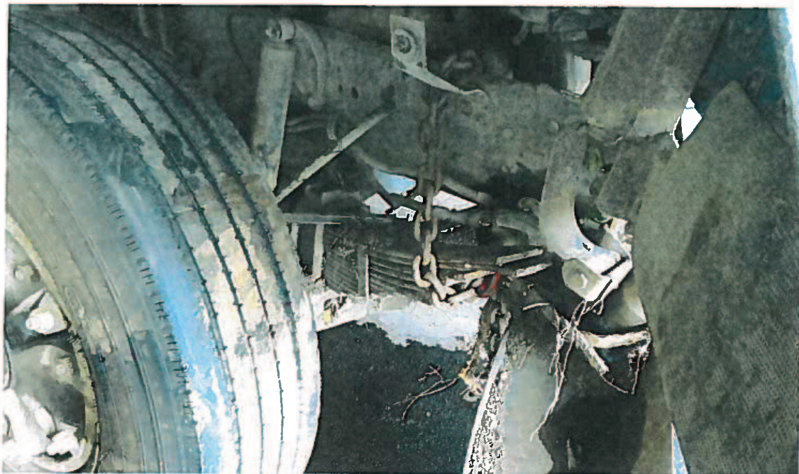
suspension casser conduite a ceder lors de l impact cote avant droit
