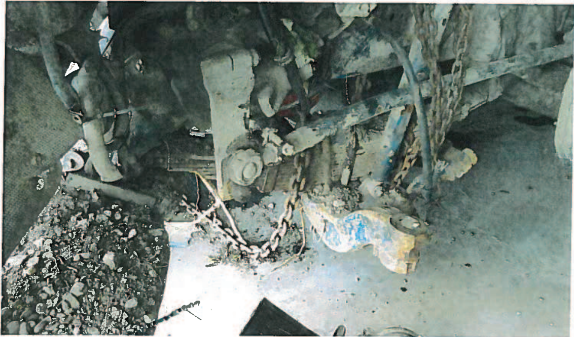
cote avant gauche suspension et direction frein arracher lors de l'impact
