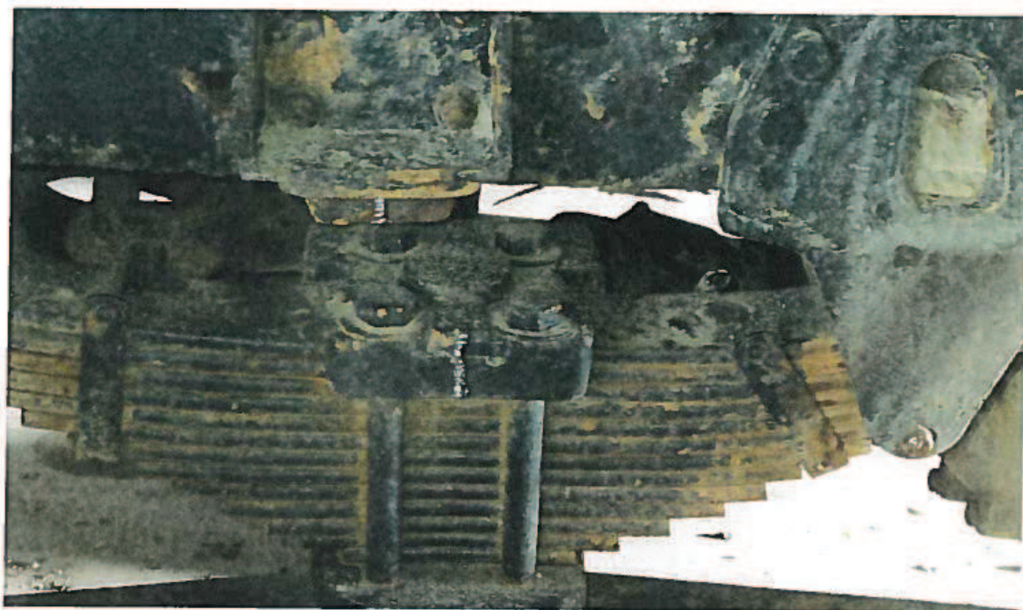
deplacement de l'essieux vers l'arriere
