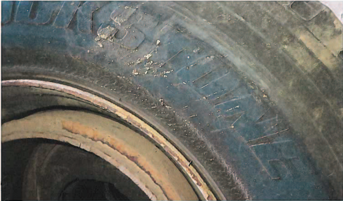
usure pneu flanc interieure du au deplacement de l essieux
