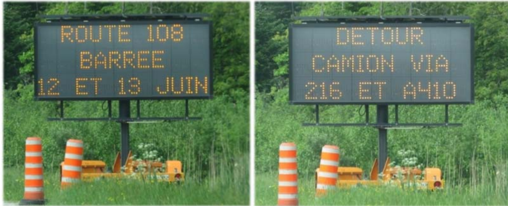
Figure 9 : Panneau à message variable installé avant l'intersection de la route 108 est
