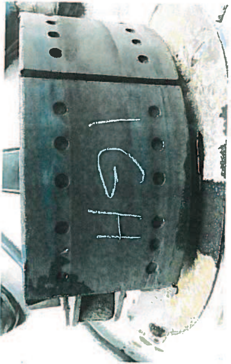
Sabot freins 1er ess. g. (6mm)
