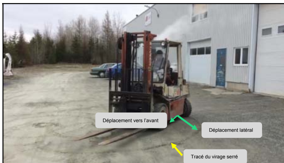
Figure 14 : Déplacement du chariot élévateur pendant l'exécution d'un virage serré
