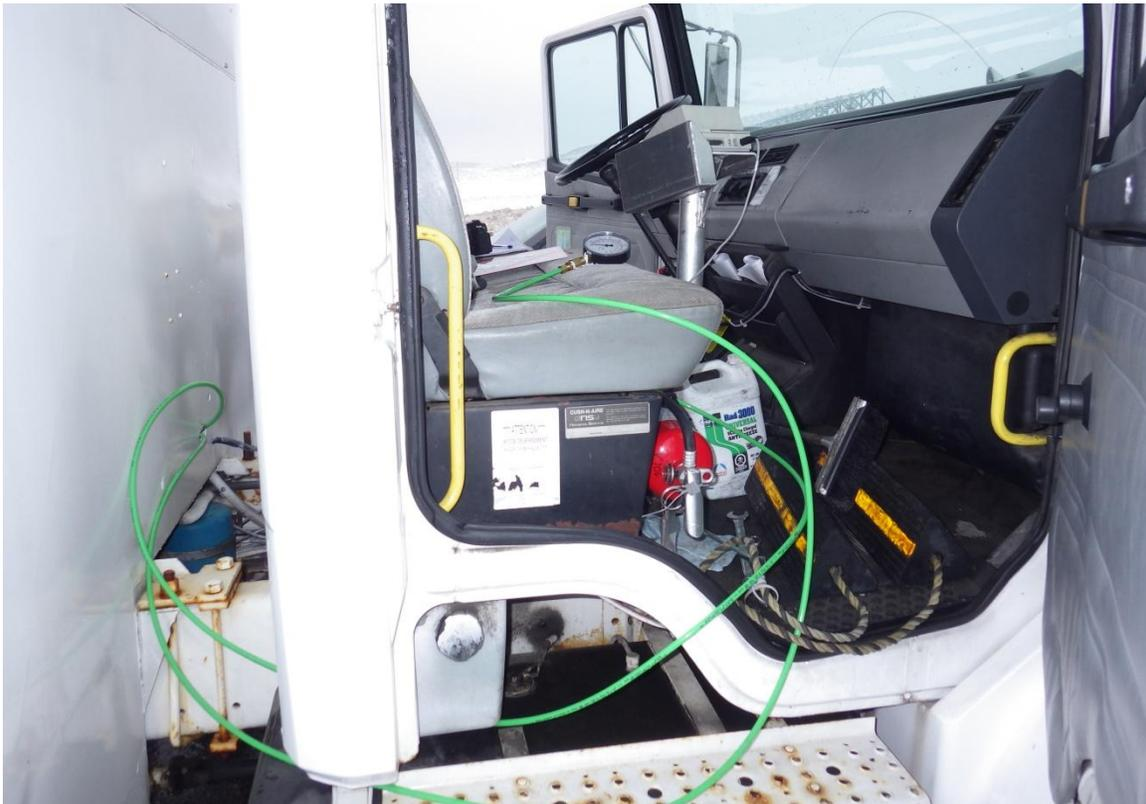
**Photo 54 :** Vue générale des conduites pneumatiques et du manomètre installés pour les essais sur route.
