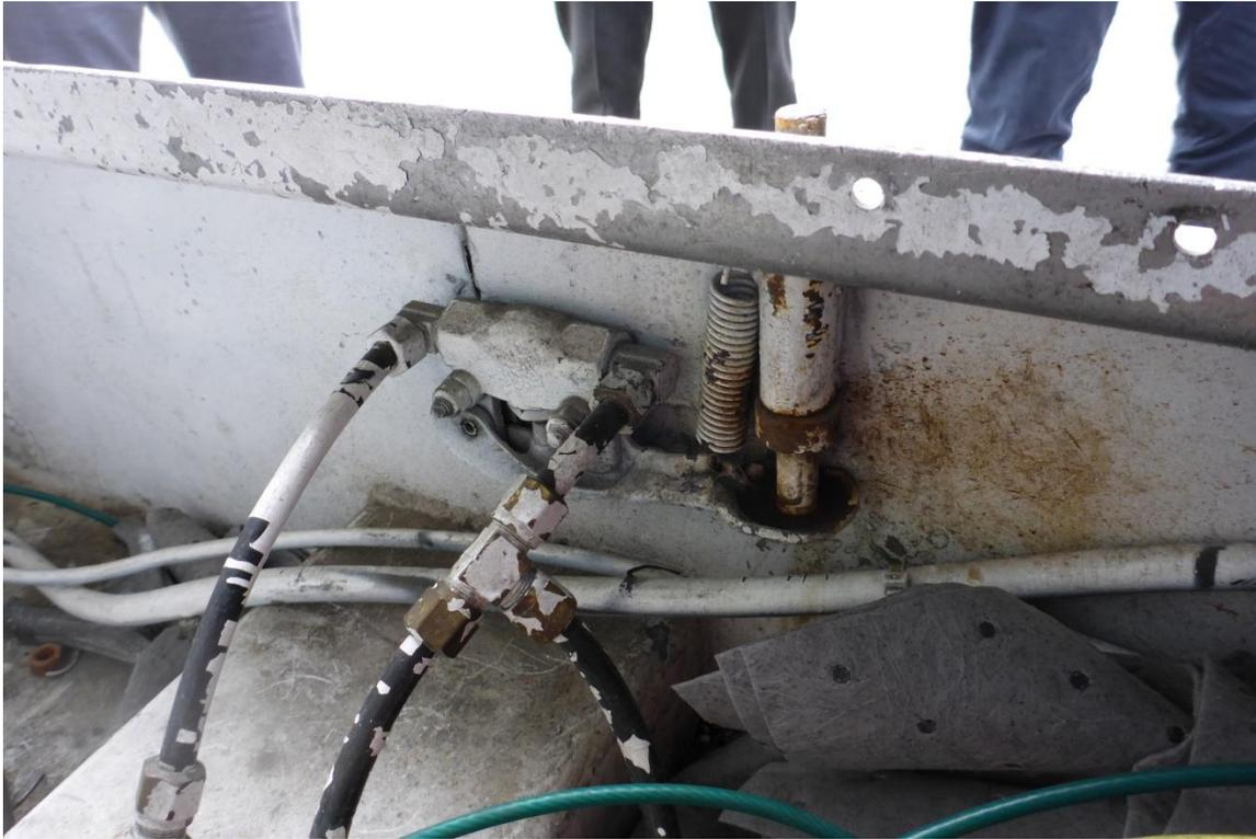
**Photo 41 :** Vue générale du culbuteur et du capteur de position du rideau latéral activant le système de sécurité «Interlock».
