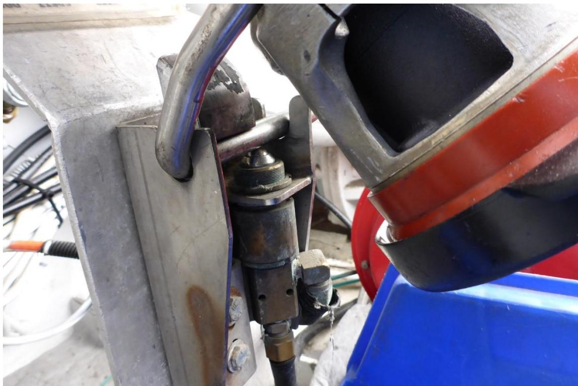
**Photo 40** : Vue générale du capteur de position de la buse d'avitaillement activant le système de sécurité «Interlock».
