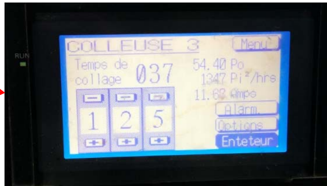
Photos 23 et 24: panneau opérateur incluant l'interface d'opération OMRON
