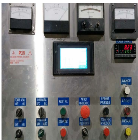
Photos 26, 27 et 28: panneau opérateur incluant indicateurs de courant et de tension de plaque de la colleuse
