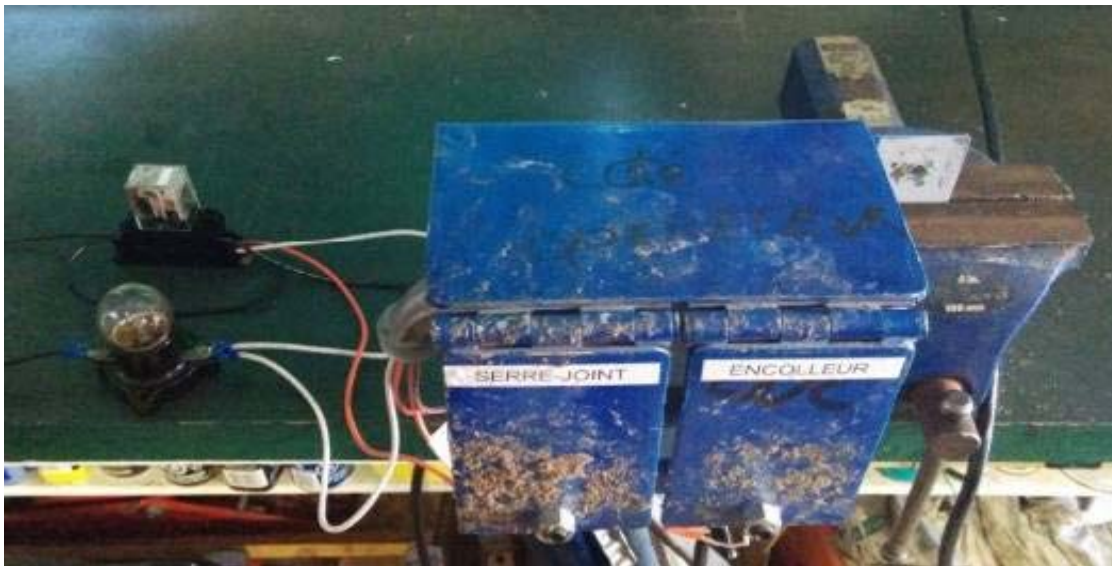
Photo 7: test du bouton de démarrage du serre-joints réalisé sous tension et sous charge
