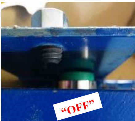
Photos 8, 9 et 10: test du bouton de démarrage du serre-joints, activé après la mi-course de son déplacement « travel »
