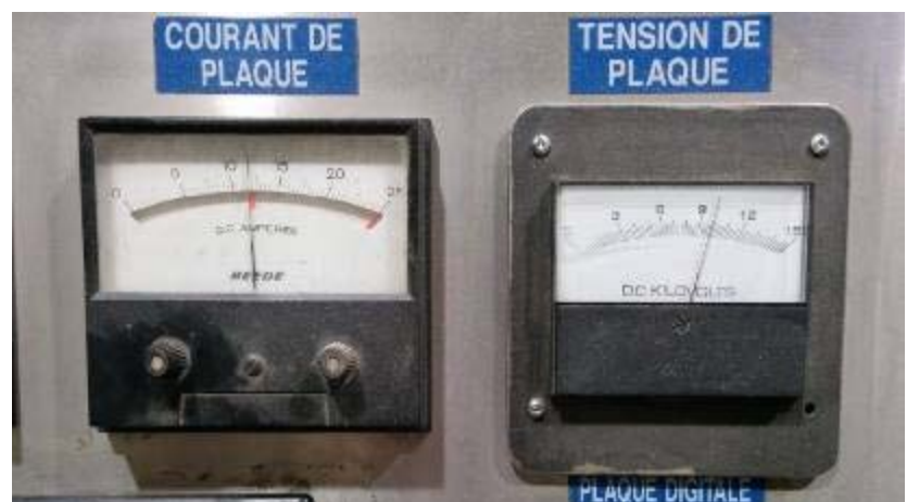
Photos 26, 27 et 28: panneau opérateur incluant indicateurs de courant et de tension de plaque de la colleuse
