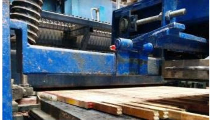
Photo 34: serres-joints en position basse (électrovanne du distributeur pneumatique des cylindres du serre-joints non activé)
