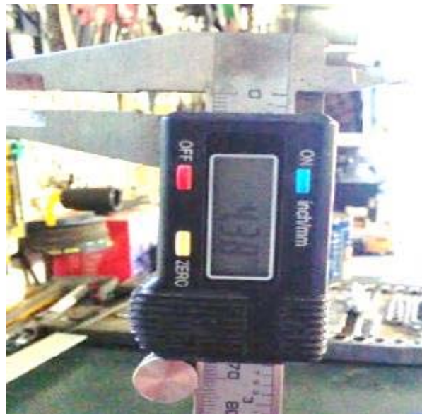
Photos 11 et 12: mesure de la course totale du bouton poussoir du serre-joints = 4,38 mm
