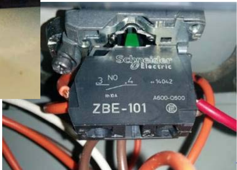
Photo 6: contact n. ouvert du bouton poussoir du serre-joints
