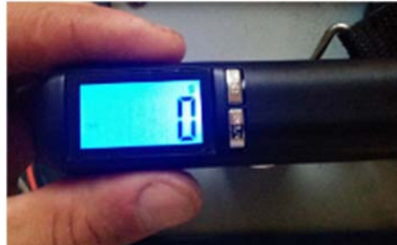
Photos 18 et 19: mise à « zéro » du capteur de poids avant le test de force
