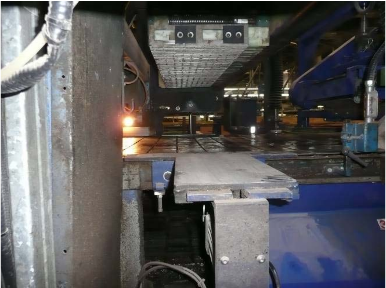
Vue latérale du serre-joints de la colleuse à bois et de la table de montage
