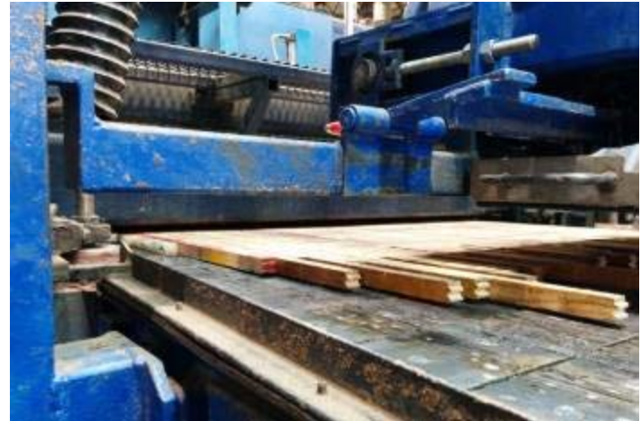
Photo 3: entrée de la colleuse, plateau en bas (serre-joints activé).
