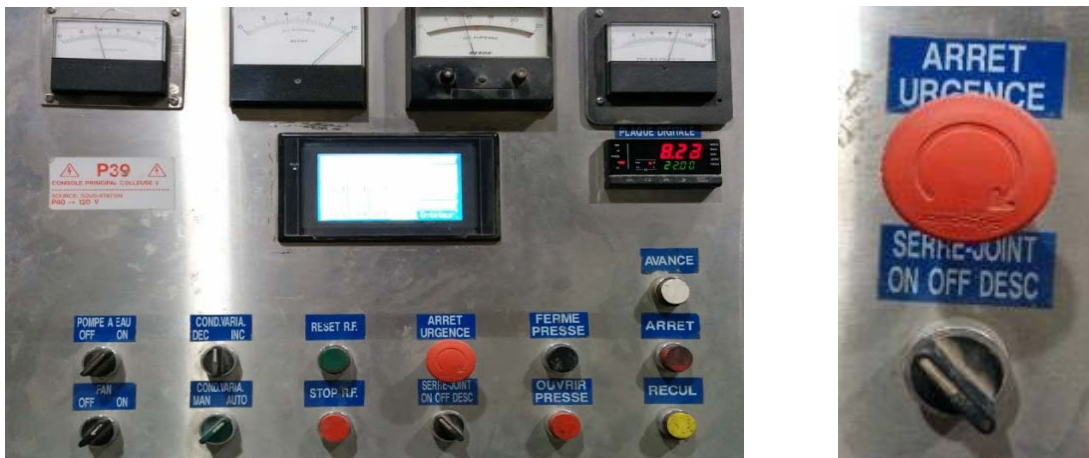
Photos 31 et 32: panneau opérateur incluant bouton d'arrêt d'urgence et sélecteur du serre-joints
