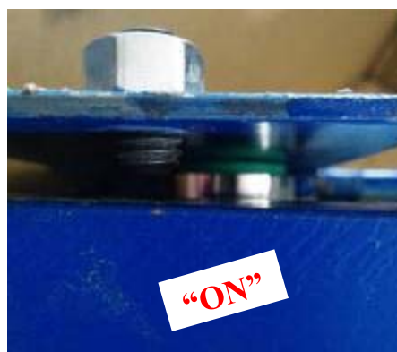
Photos 8, 9 et 10: test du bouton de démarrage du serre-joints, activé après la mi-course de son déplacement « travel »
