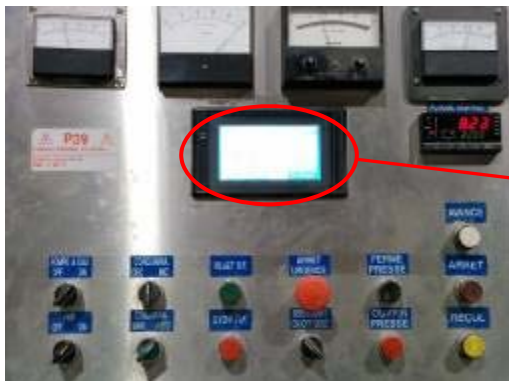
Photos 23 et 24: panneau opérateur incluant l'interface d'opération OMRON
