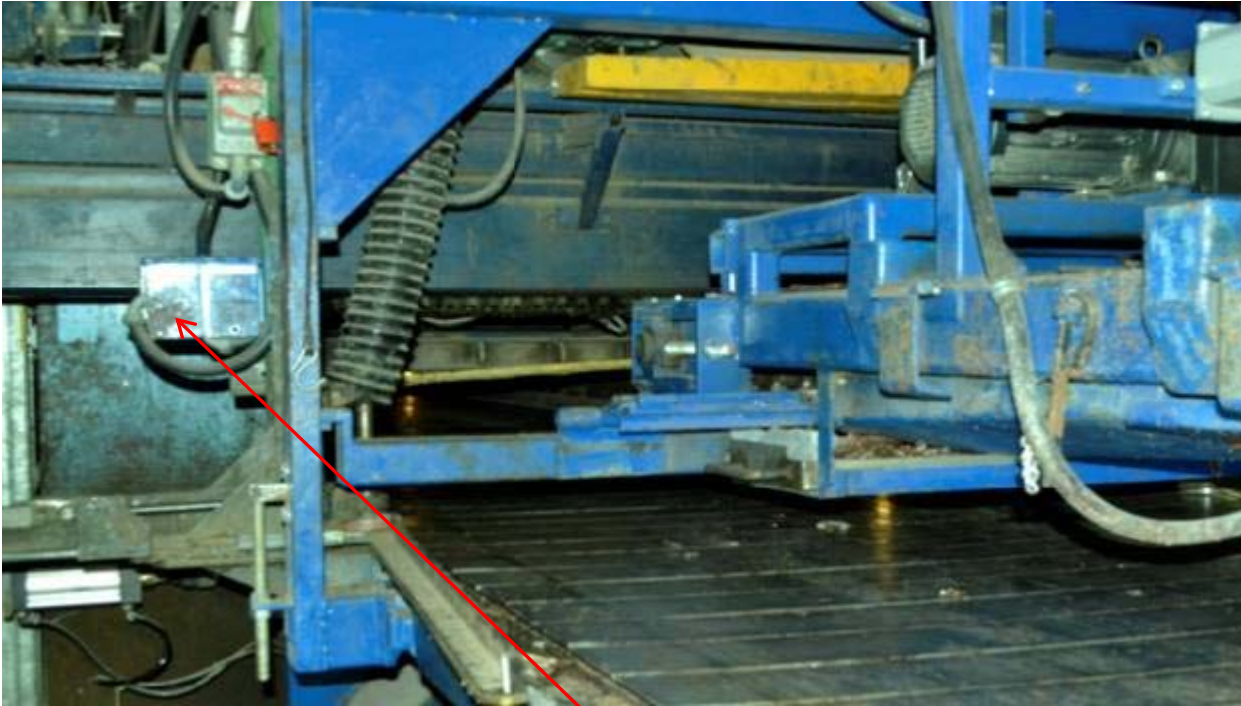
Photo 4: entrée de la colleuse, incluant le bouton de démarrage du serre-joints à gauche et le bouton de l'encolleur à droite.
