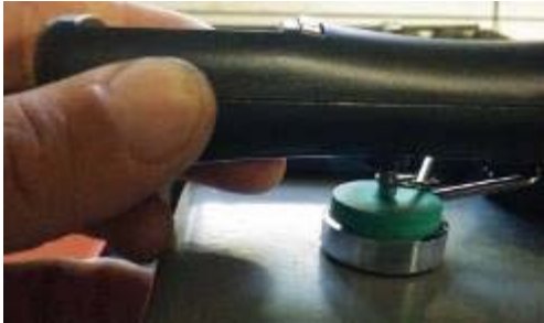
Photos 18 et 19: mise à « zéro » du capteur de poids avant le test de force
