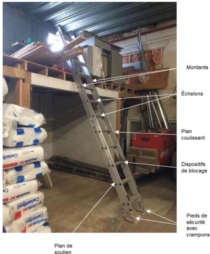
Photo 5 : Parties d'une échelle (Source CNESST)
