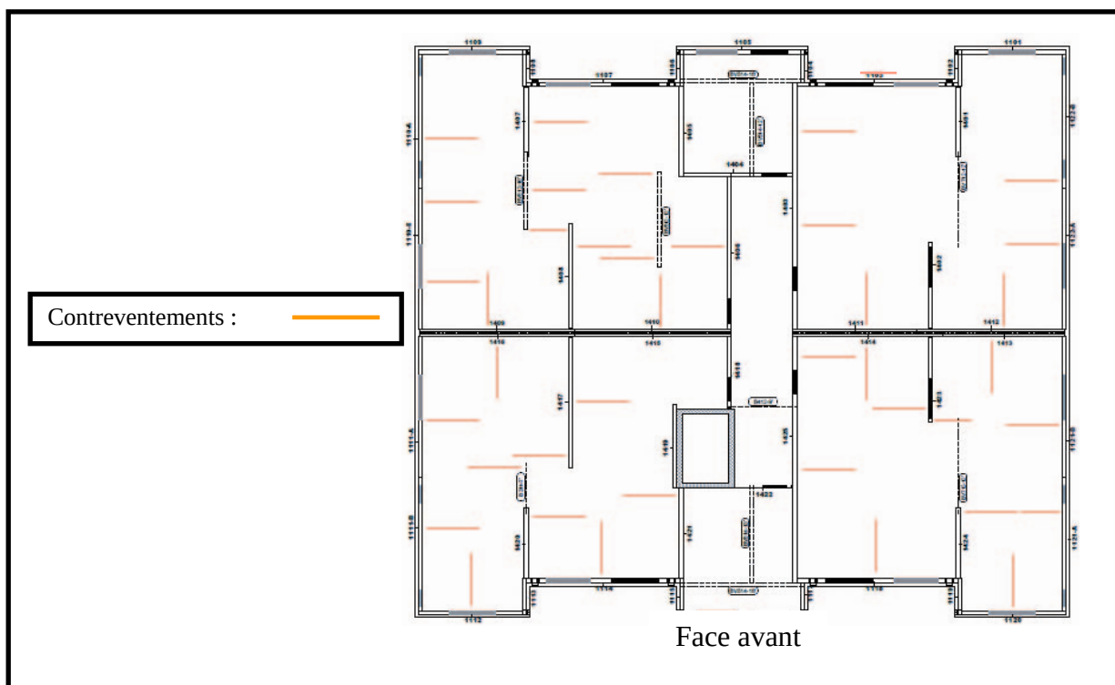
Plan 3: Positionnement des contreventements (Source : Constructions Jacques-Dubois et Fils inc., modifié par la CNESST)
