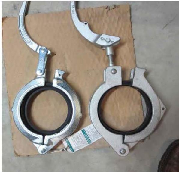
**Photographie 4 : Collets neufs (sans et avec ajustement)**
